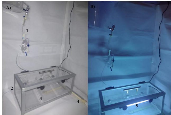
Figura 11. Prototipo de Multi-descelularizador-UV. Prototipo de Multi-descelularizador-UV. A) Muestra el prototipo con la fuente de luz UV apagada; B) Luz UV encendida; 1) Sistema de perfusión; 2) Cámara de descelularizado; 3) Camas de descelularizado; 4) Sistema de drenaje; 5) Fuente de Luz UV. Fuente: Hernández-Carrillo Diego A., 2022.
