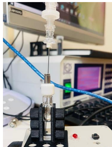
Figura 11.3.a Fotografía del sistema de inyección de \text{CO}_2
