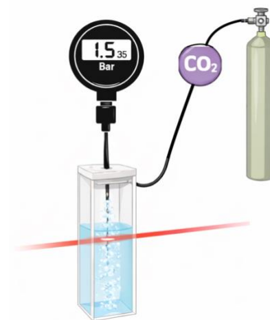
Figura 8.3.a Ilustración de la preparación de muestras en cubeta óptica expuesta a un láser. Figura creada con BioRender.com
