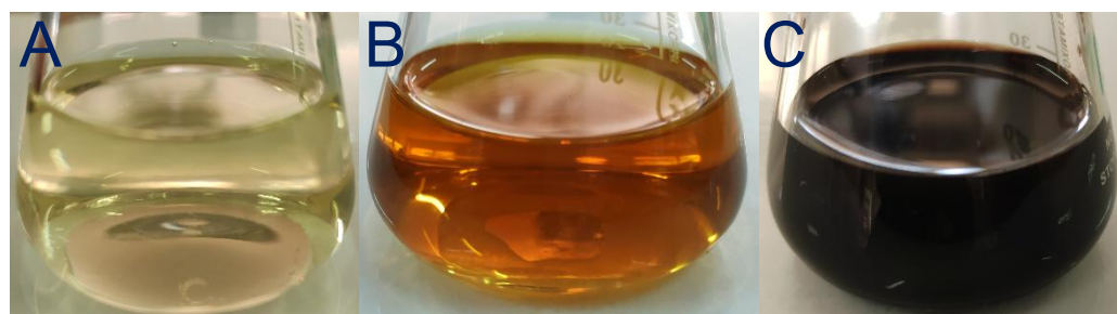
Figura 3. Cambio de color de la solución en el proceso de síntesis de las AgNPs. Infusión obtenida de O. basilicum (A), ajuste a pH 12 (B), solución al finalizar las 24 h de agitación después de la adición de \text{AgNO}_3 (C).
