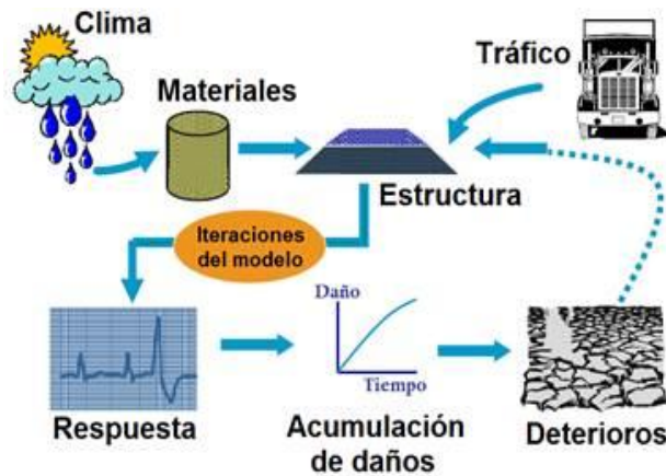
Figura 4.4 Factores que afectan el pavimento,
