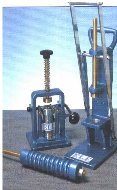
Figura 7 Equipo de compactación Harvard (ELE Internacional Ltda., 1993)
