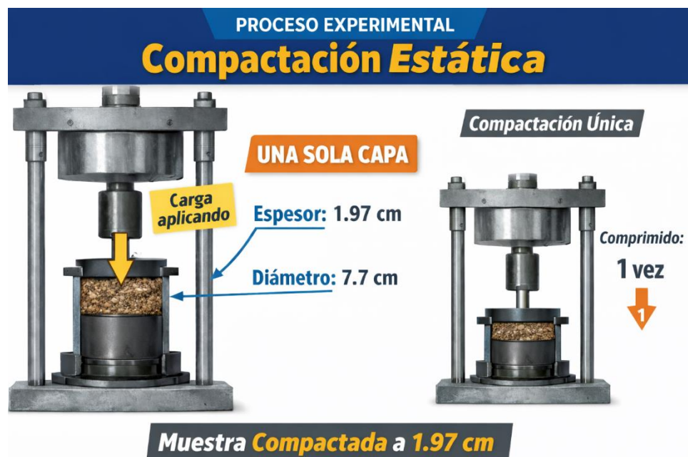
Figura 23 Esquema conceptual del procedimiento de compactación estática. Fuente: Elaboración propia con apoyo de herramientas de inteligencia artificial generativa.
