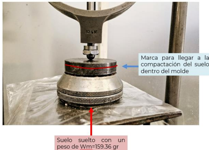
Figura 22 Compactación estática para consolidación
