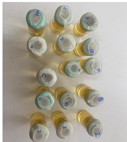
Figura 4: Modelos de doble cámara, identificados con la inicial de cada cemento.
