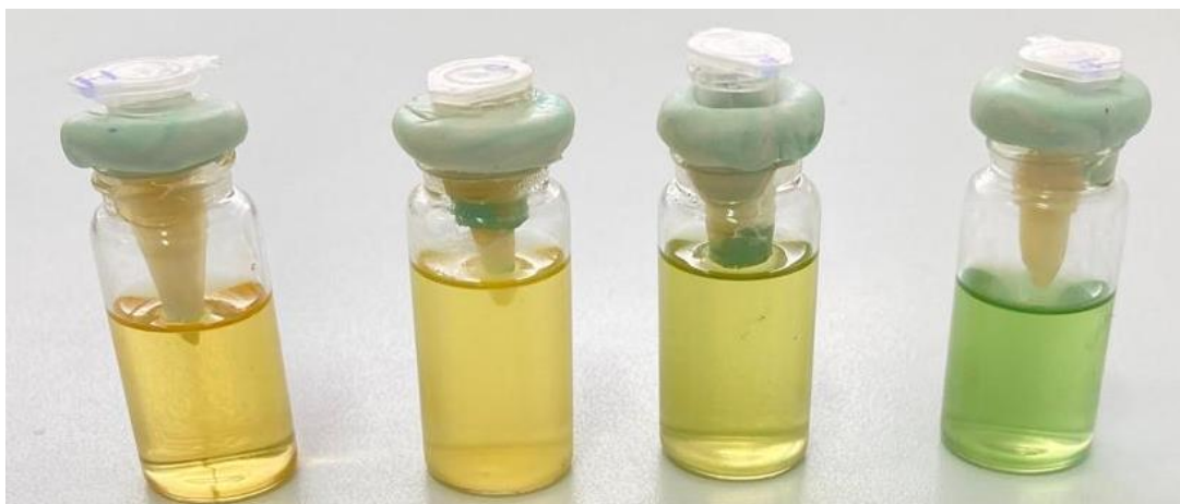
Figura 4: Muestra de control positivo que muestra filtración bacteriana en los primeros 3 días.
