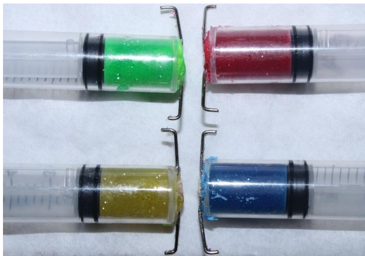
Figura 1: Jeringas con acrílico de color diferente para cada grupo y guías de inserción.
