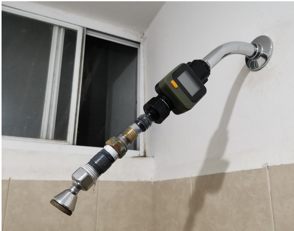
Figura 47. Sistema de monitoreo adaptado a llave de salida de agua de la regadera.
