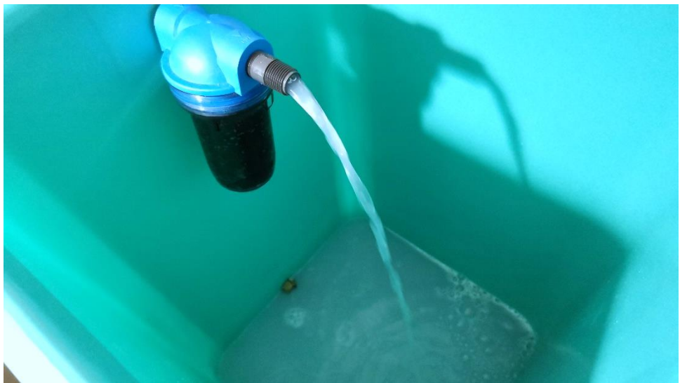
Figura 31. Prototipo funcional con filtro con carbón activado granulado.
