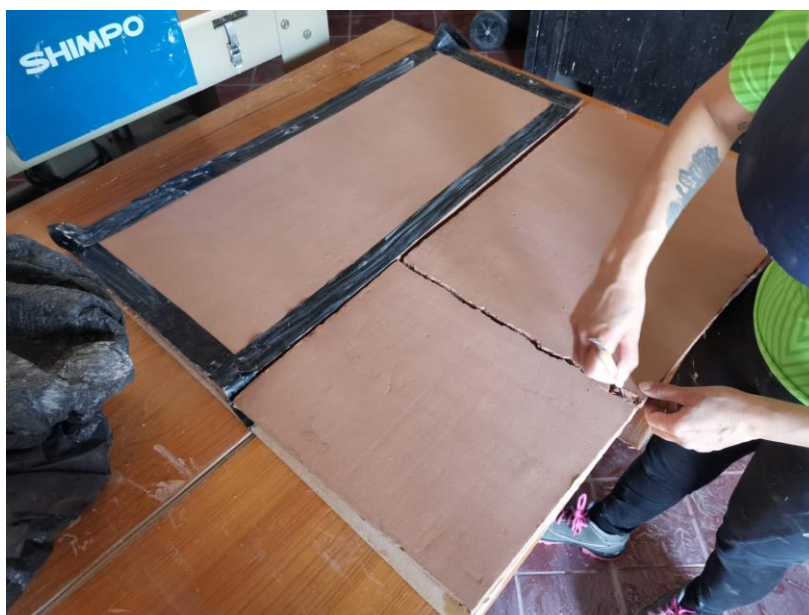
Figura 43. Reacción de las placas cerámicas ante la deshidratación y contracción. Elaboración propia, 2025.
