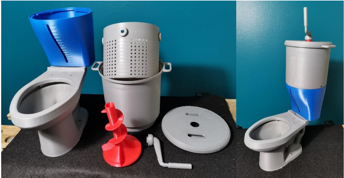
Figura 25. Componentes y ensamble de maqueta construida en impresión 3D de extrusión de filamento a Escala 1:3 de la propuesta 3. Elaboración propia, 2024.
