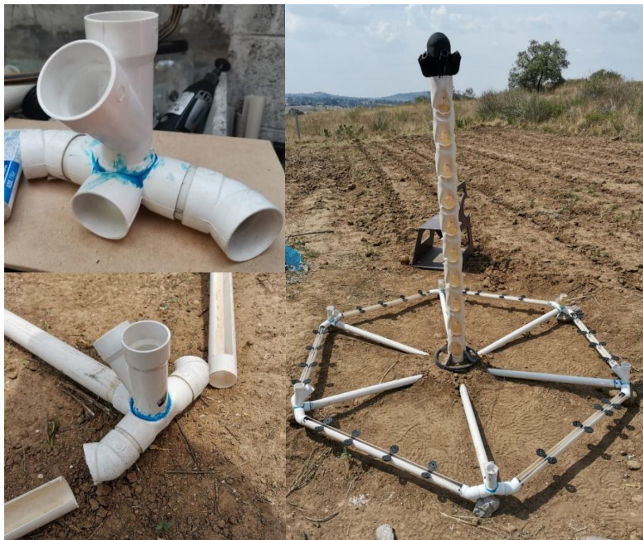
Figura 63 Rediseño de los conectores principales (Elaboración propia, 2024)
