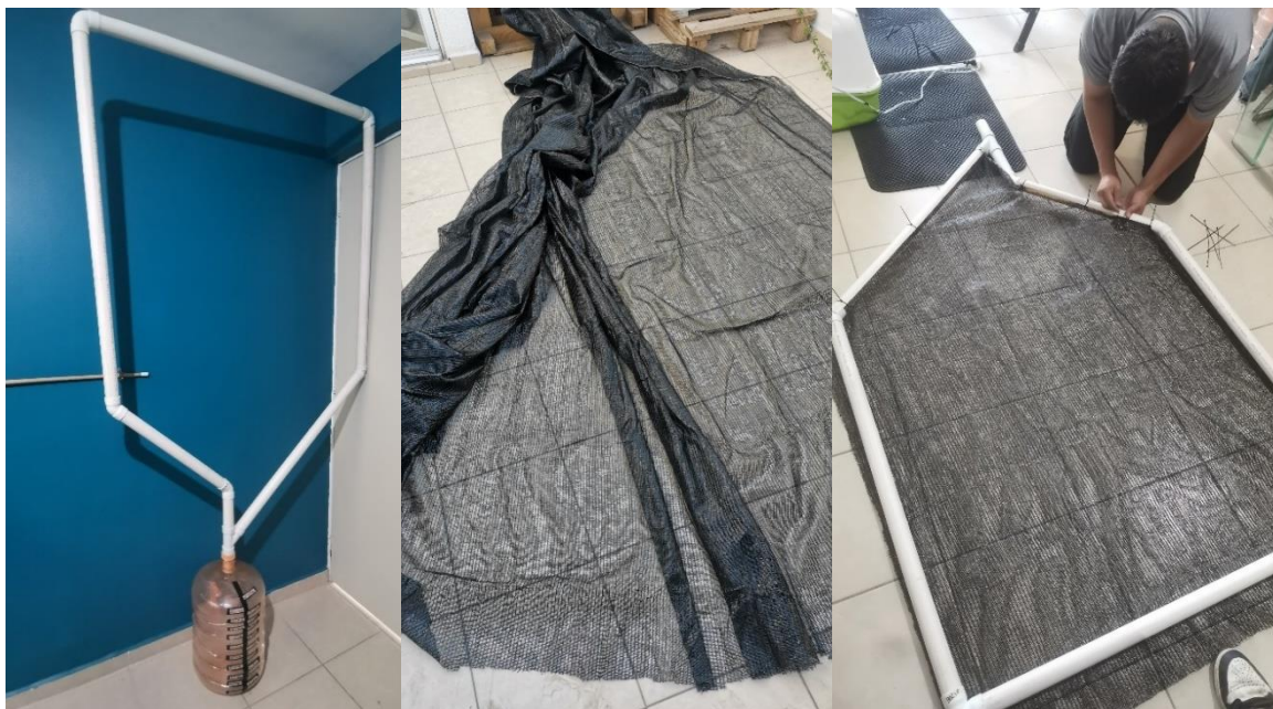
Figura 56 Ensamble de la estructura, malla Raschel y contenedor (Elaboración propia, 2024)
