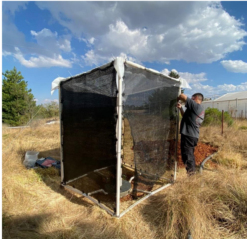
Figura 73 Instalación de mallas Raschel y captador pluvial (Elaboración propia, 2024)
