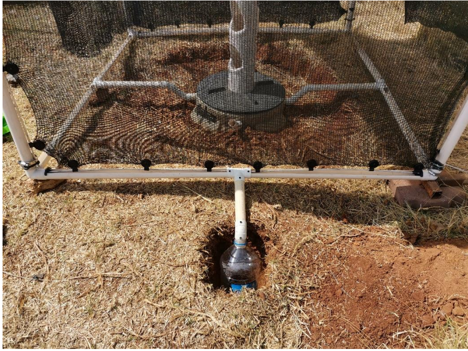
Figura 76 Prueba de validación de captación de agua de niebla (Elaboración propia, 2025)
