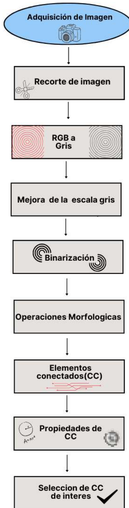
Figura 5.8: Algoritmo desarrollado en Matlab para la obtención de características de los elementos del patrón de difracción [elaboración propia]
