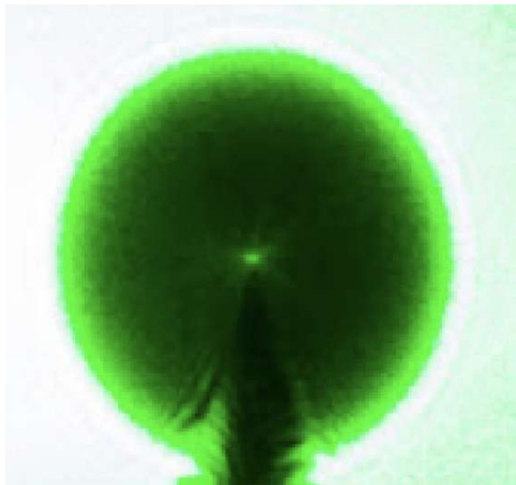
Figura 2.1: Formación de punto luminoso (punto de Arago) sobre la sombra de un objeto circular, debido a el fenómeno de interferencia constructiva de la luz (Elaboración propia).
