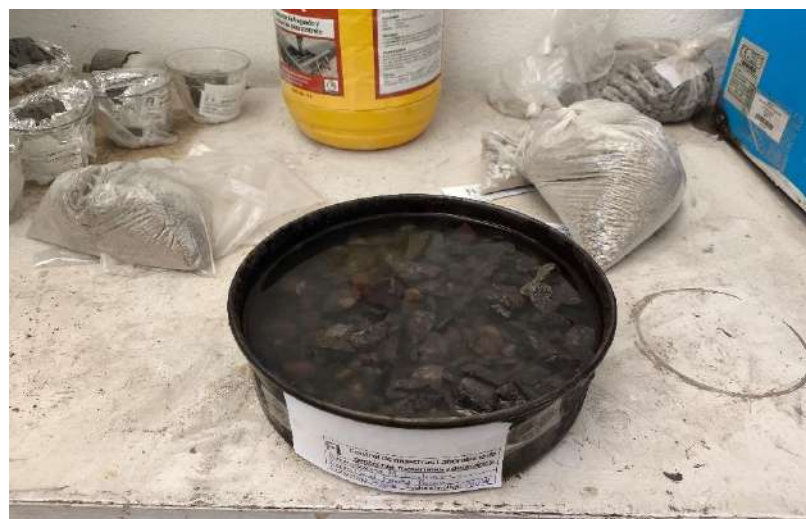
Fig. 19 Muestra de grava dejándose saturar por 24 hrs para la prueba de absorción.
