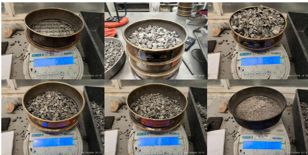
Fig. 15 Peso obtenido en cada tamiz durante el cribado de la muestra de grava elegida.
