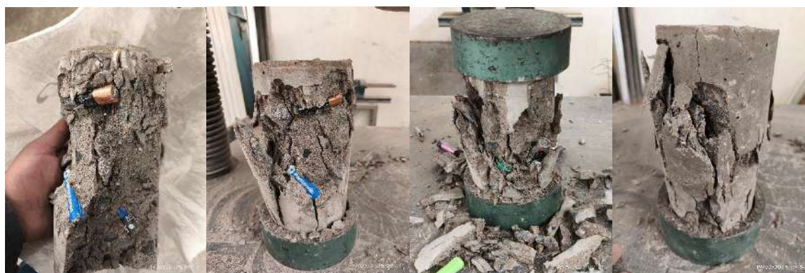
Fig. 59 Cilindros ensayados a compresión a 28 días.
