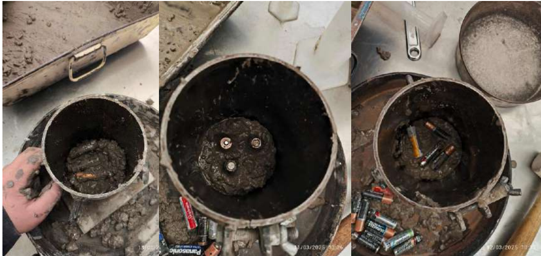
Fig. 47 Vaciado de mezcla con pilas, colocando las pilas manualmente en las siguientes posiciones: al azar, vertical y horizontal respectivamente.
