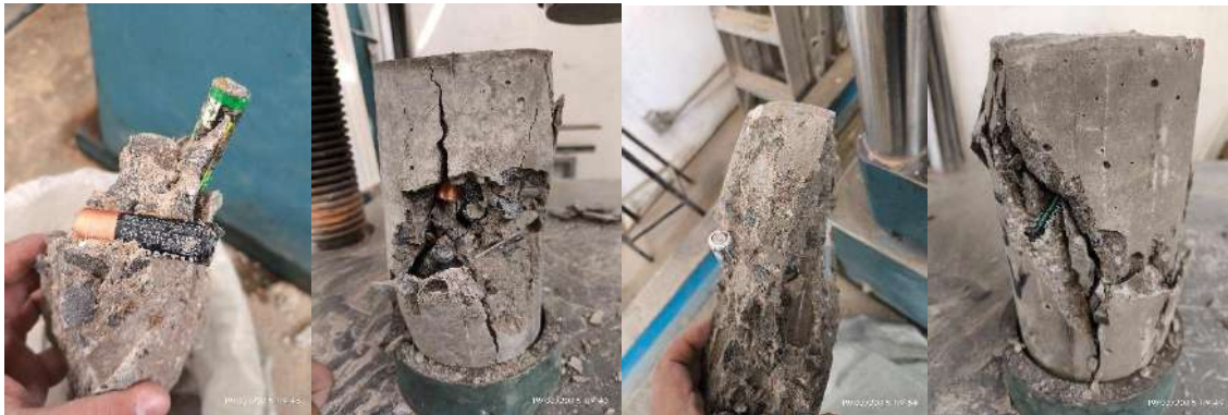
Fig. 56 Cilindros ensayados a compresión a 28 días.
