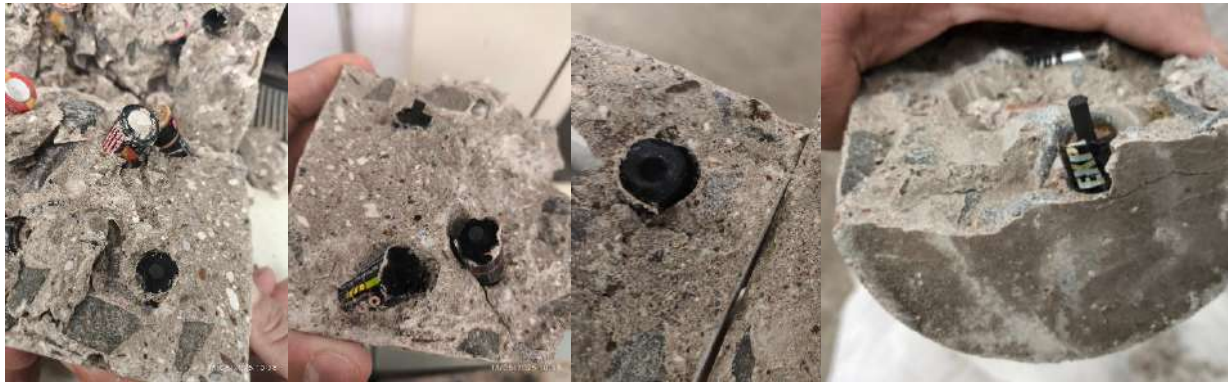
Fig. 77 Pilas que se rompieron a la mitad durante la prueba de RTD.
