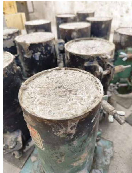
Fig. 39. Vaciado de la mezcla natural de concreto.
