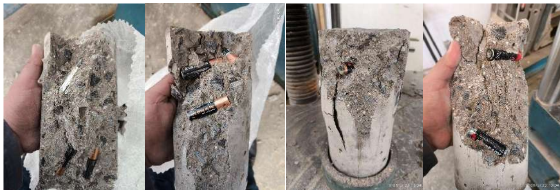
Fig. 61 Cilindros ensayados a compresión a 28 días. Elaboración propia.
