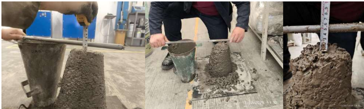
Fig. 46 Parte del proceso de la obtención del revenimiento de la mezcla.
