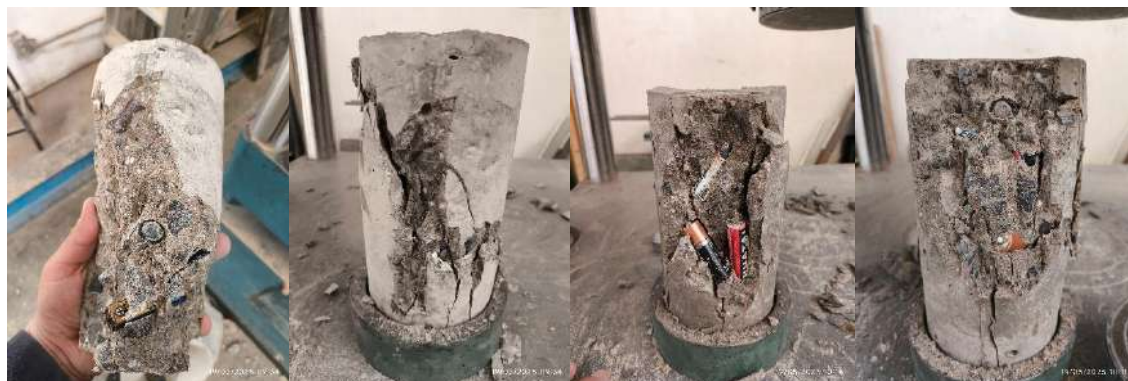
Fig. 58 Cilindros ensayados a compresión a 28 días.
