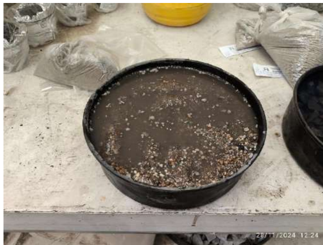
Fig. 31 Muestra de arena dejándose saturar por 24 hrs para la prueba de absorción.
