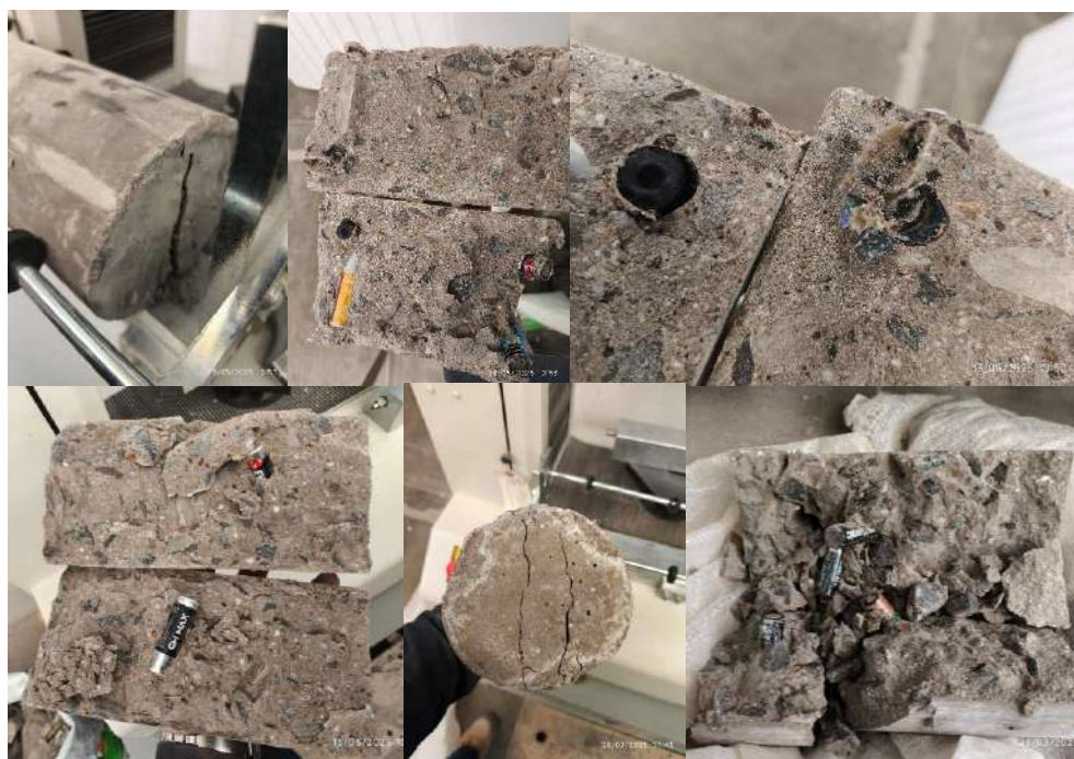
Fig. 70 Cilindros ensayados a tensión diametral 28 días.
