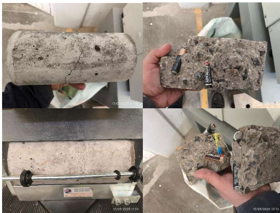
Fig. 68 Cilindros ensayados a tensión diametral 28 días.
