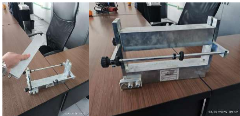
Fig. 66 Aparato de ensayo para la prueba de tensión diametral.
