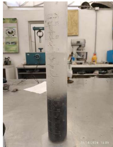
Fig. 25 Volumen desplazado por la muestra de grava de 498 gr.
