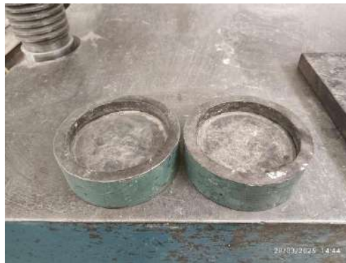
Fig. 54 Almohadillas de neopreno usadas en la prueba de compresión simple para cilindros de 10 x 20 cm.
