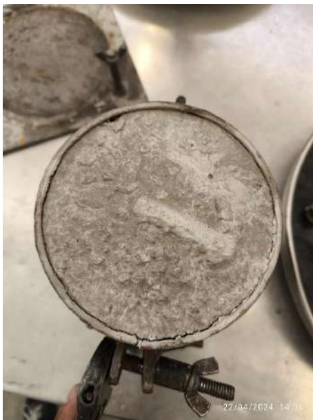
Fig. 42. Vaciado de la mezcla preliminar con pilas.
