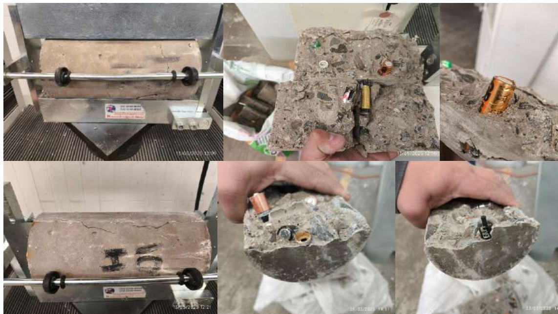
Fig. 73 Cilindros ensayados a tensión diametral 28 días.
