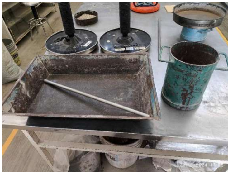
Fig. 8 Materiales a usar para la obtención del peso volumétrico seco y compacto para gravas según Norma ASTM C29.
