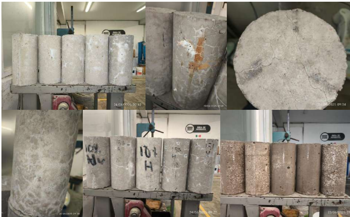
Fig. 100 Especímenes después de 24 hrs sumergidos, 24 hrs secos y algunos cambios físicos que se notaron durante los ciclos.
