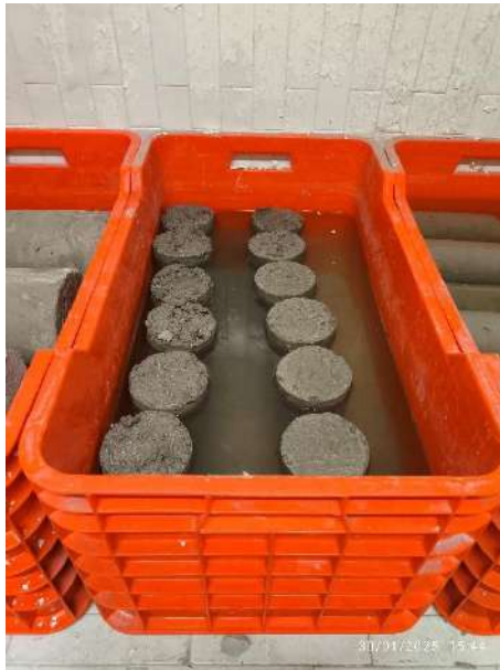
Fig. 43. Curado de los cilindros.
