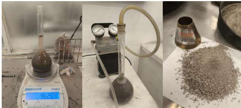
Fig. 38 Proceso de obtención de la densidad de arena.
