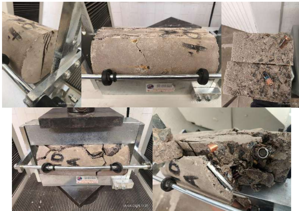
Fig. 71 Cilindros ensayados a tensión diametral 28 días.
