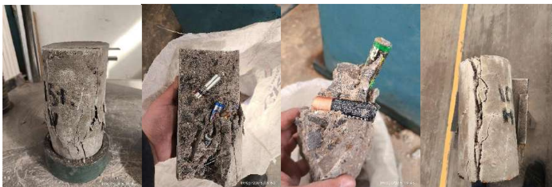
Fig. 63 Cilindros ensayados a compresión a 28 días. Elaboración propia.
