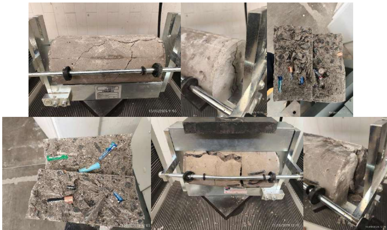
Fig. 72 Cilindros ensayados a tensión diametral 28 días.
