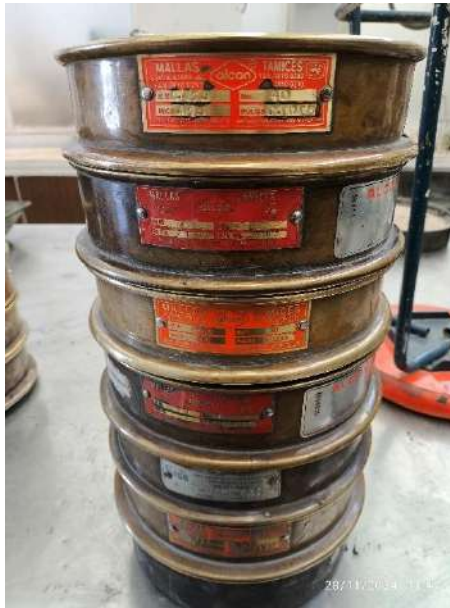
Fig. 9 Tamices utilizados para la granulometría de las arenas según Norma ASTM C136.
