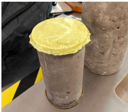
Fig. 44. Cabeceo de los cilindros con azufre.
