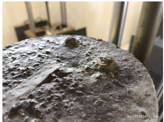
Fig. 41. Vaciado de la mezcla preliminar con pilas.
