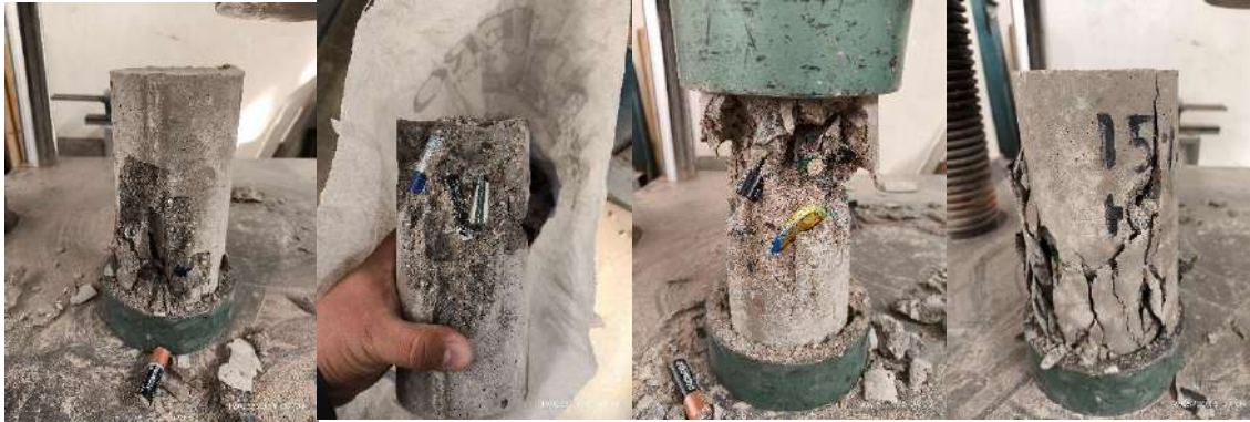
Fig. 64 Cilindros ensayados a compresión a 28 días.
