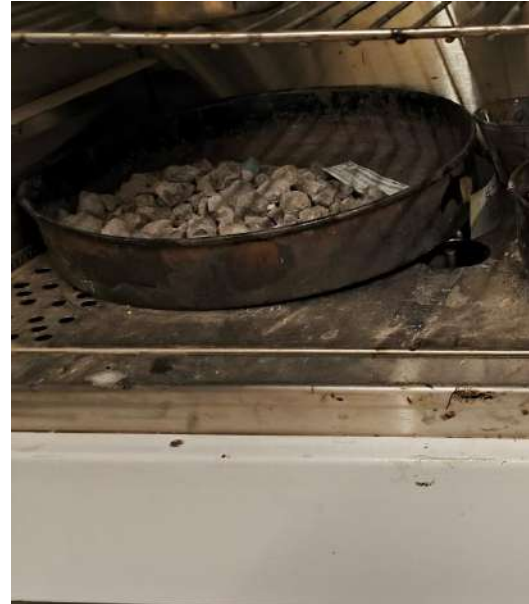
Fig. 18 Muestra de grava secándose al horno por 24 hrs como lo marca la Norma ASTM C566.
