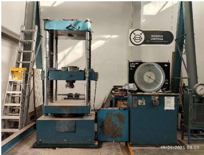
Fig. 13 Maquina Universal marca Fourney la cual se utilizará para las pruebas de compresión y flexión.
