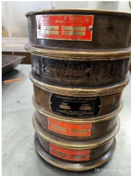
Fig. 7 Tamices utilizados para la granulometría de las gravas según norma ASTM C136.
