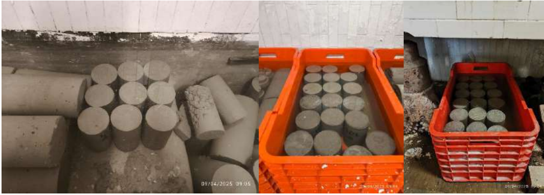
Fig. 49 Curado de los especímenes de concreto.
