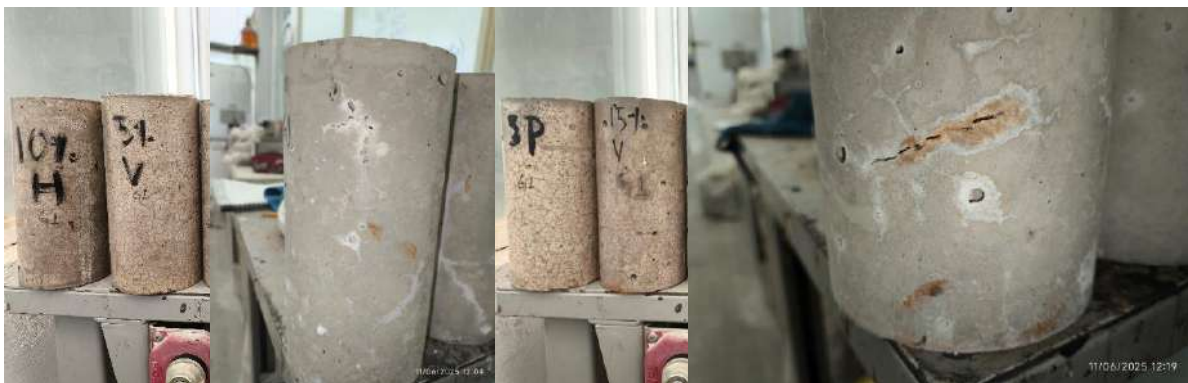
Fig. 101 Grietas y fisuras presentadas durante la prueba de degradación de sulfatos.
