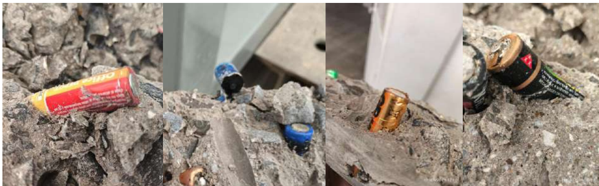
Fig. 78 Pilas que se aplastaron durante la prueba de RTD.
