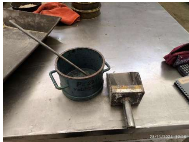
Fig. 11 Materiales a usar para la obtención del peso volumétrico seco y compacto de arenas según la Norma ASTM C29.
