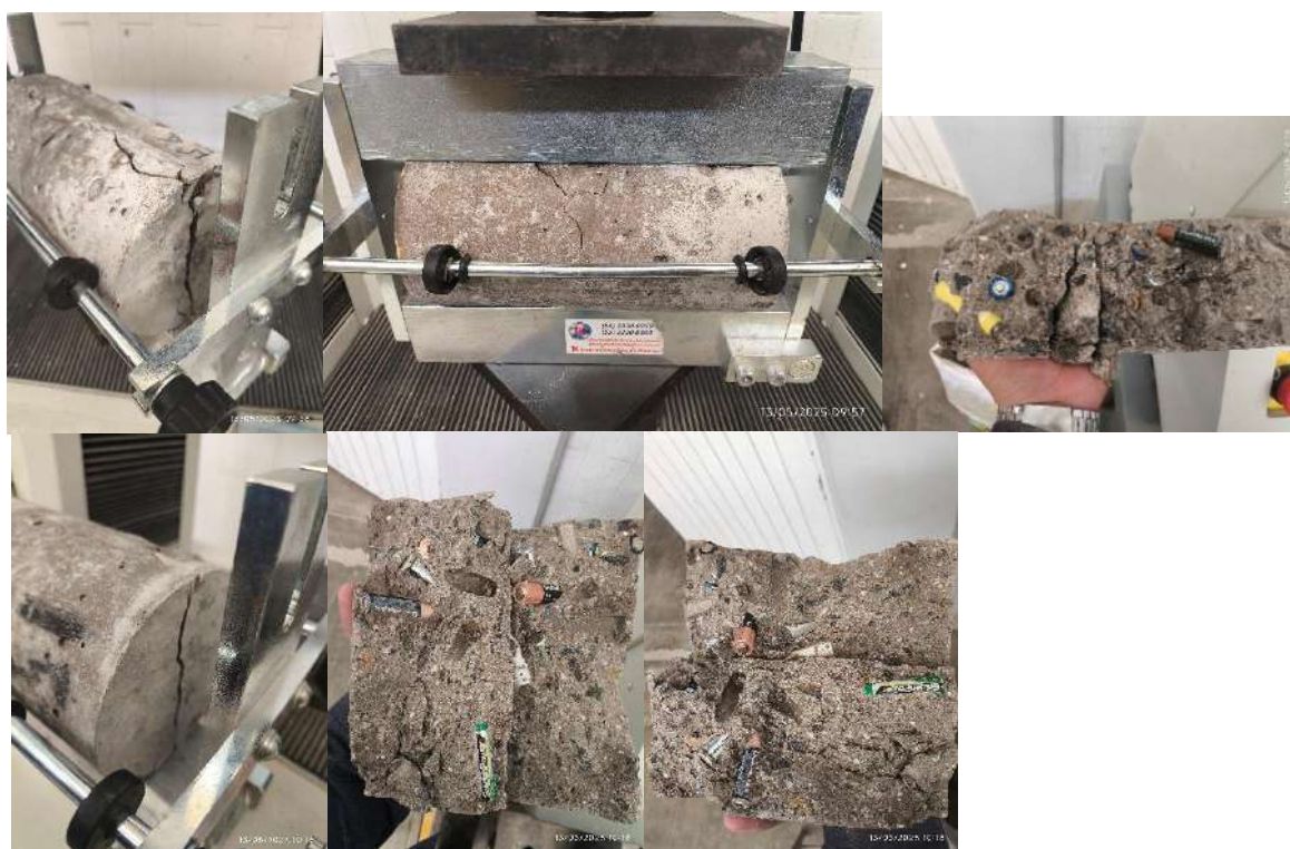
Fig. 74 Cilindros ensayados a tensión diametral 28 días.
