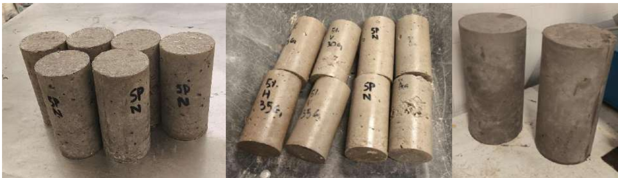
Fig. 48 Desmoldado de los distintos especímenes.
