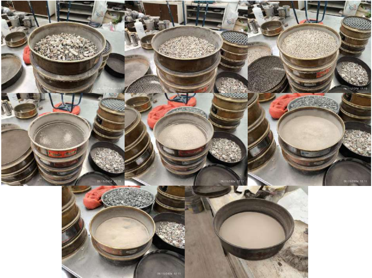
Fig. 27 Peso obtenido en cada tamiz durante el cribado de la muestra de arena elegida. Fuente propia.
