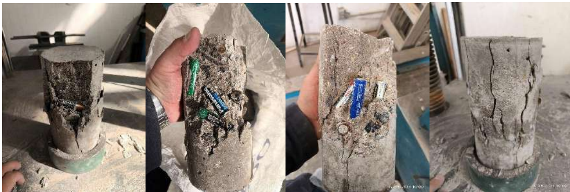
Fig. 57 Cilindros ensayados a compresión a 28 días.
