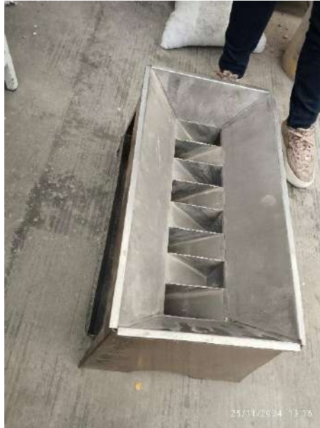
Fig. 6 Cuarteador mecánico para las distintas muestras representativas a utilizar.
