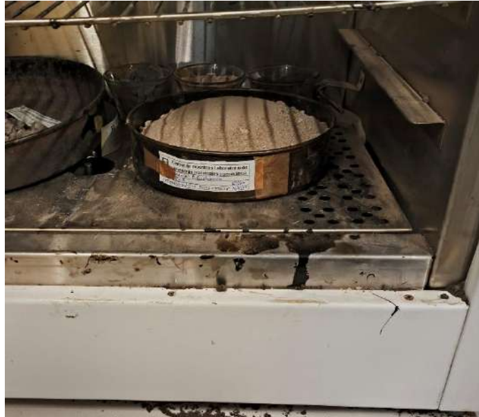
Fig. 29 Muestra de arena secándose al horno por 24 hrs como lo marca la Norma ASTM C566. Fuente propia.
