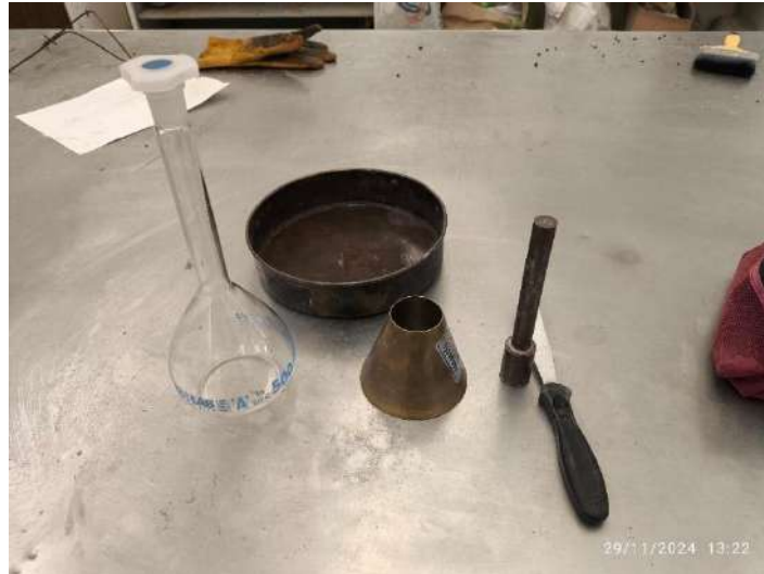
Fig. 10 Materiales necesarios para prueba de absorción y densidad según la Norma ASTM C127.
