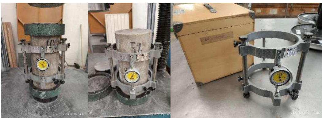
Fig. 50 Anillos de deformación colocados sobre los especímenes de 30x15cm.
