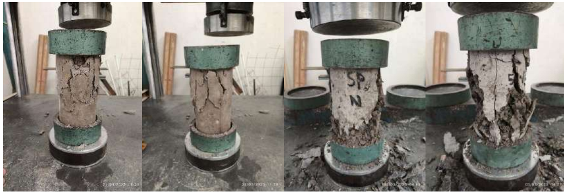
Fig. 55 Cilindros ensayados a compresión a 28 días.
