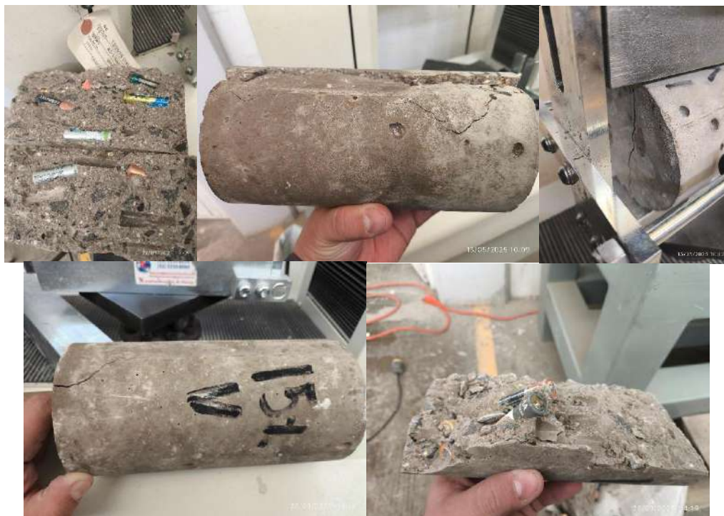
Fig. 75 Cilindros ensayados a tensión diametral 28 días.
