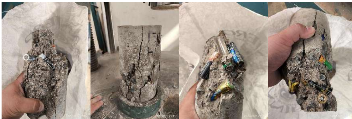
Fig. 62 Cilindros ensayados a compresión a 28 días. Elaboración propia.
