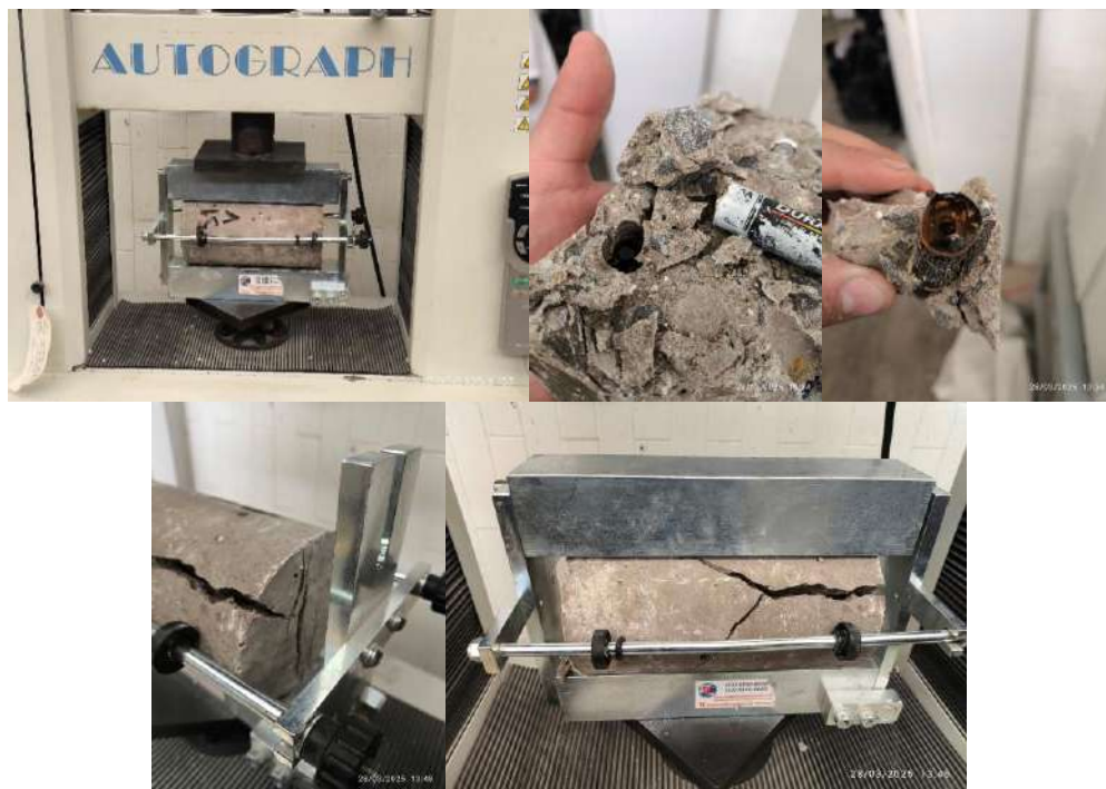
Fig. 69 Cilindros ensayados a tensión diametral 28 días.
