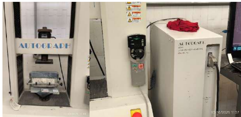
Fig. 65 Maquina universal de 50kn, marca AUTOGRAPH.
