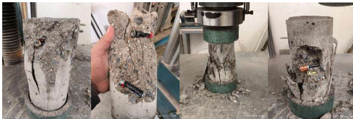
Fig. 60 Cilindros ensayados a compresión a 28 días.
