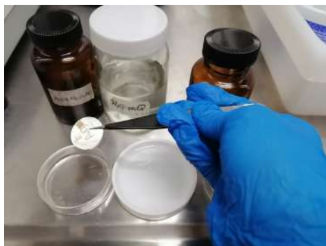
Figura 4.2: La muestra se limpia usando agua mili-Q, acetona y metanol.
