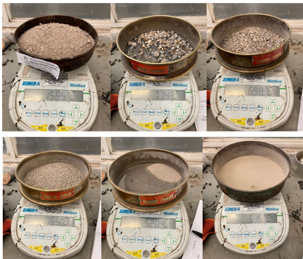
Imagen 7. Arena retenida en prueba de granulometría. Imagen propia.
