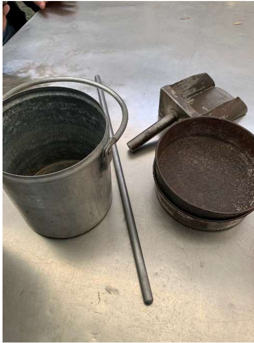
Imagen 4. Materiales para la obtención del peso volumétrico seco y compacto de arenas según la Norma ASTM C29. Imagen propia.
