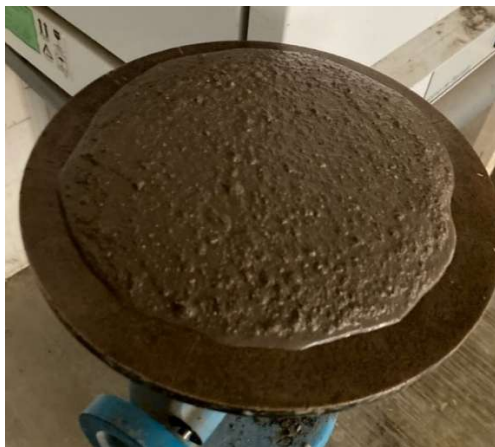
Imagen 6. Expansión de mortero sobre mesa de fluidez. Imagen propia.
