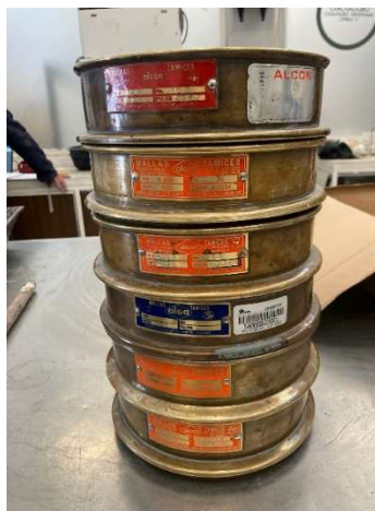
Imagen 3. Tamices utilizados para la granulometría de las arenas según Norma ASTM C136. Imagen propia.
