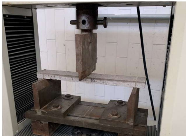
Imagen 22. Ensayo a flexión en 3 puntos. Imagen propia.
