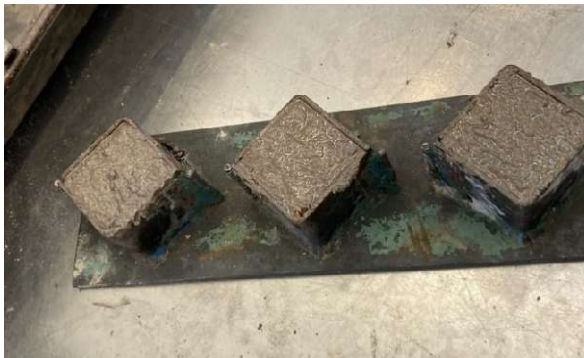
Imagen 12. Especímenes en moldes para pruebas de compresión. Imagen propia.
