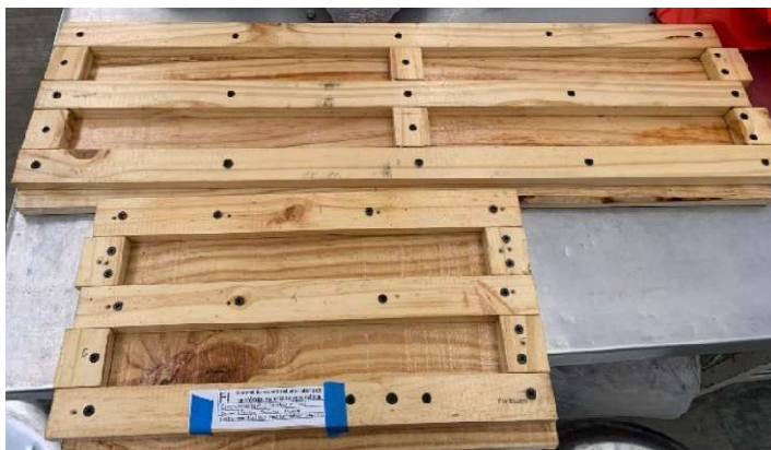
Imagen 18. Moldes para especímenes de pruebas a flexión. Imagen propia.
