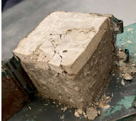
Imagen 24. Especimen con 6% de HGM. Imagen propia.
