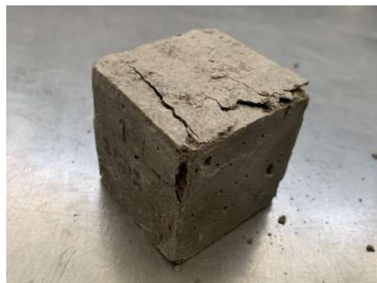
Imagen 17. Espécimen sometido a prueba de compresión. Imagen propia.
