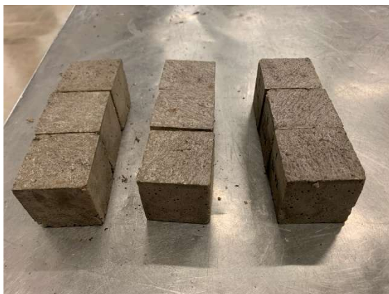
Imagen 14. Especímenes para pruebas de compresión. Imagen propia.
