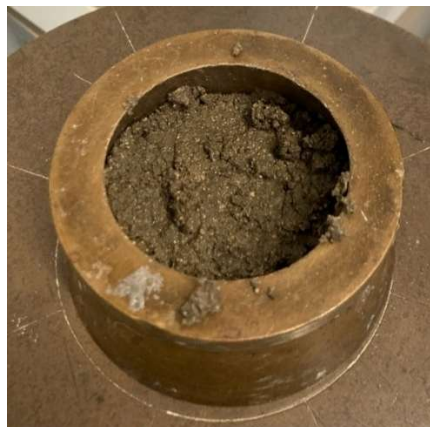
Imagen 10. Preparación de mezcla de mortero en prueba de fluidez. Imagen propia.
