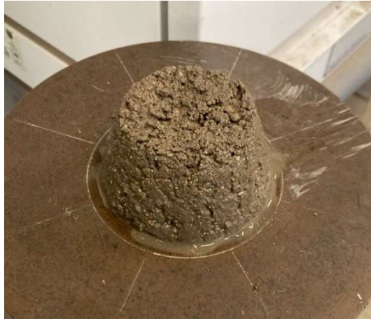
Imagen 11. Mezcla de mortero en prueba de fluidez. Imagen propia.
