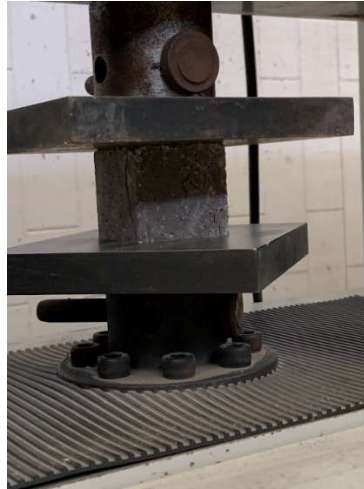
Imagen 16. Prueba de compresión a primeros especímenes de mortero. Imagen propia.
