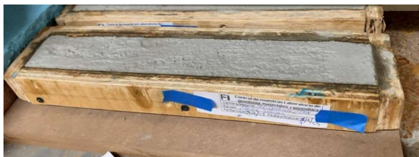
Imagen 19. Especimen en molde para prueba de flexión. Imagen propia.
