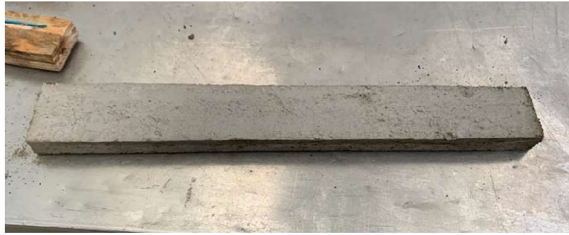
Imagen 20. Espécimen para prueba a flexión. Imagen propia.
