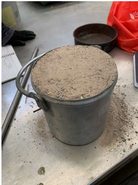
Imagen 8. Prueba de peso volumétrico de arena. Imagen propia.
