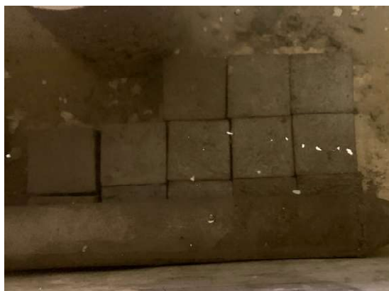
Imagen 15. Especímenes para pruebas de compresión en su proceso de curado. Imagen propia.
