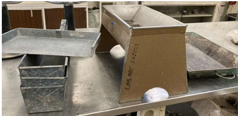
Imagen 2. Cuarteo mecánico para mezclas representativas. Imagen propia.
