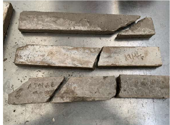
Imagen 25. Especímenes con 6% de HGM. Imagen propia.
