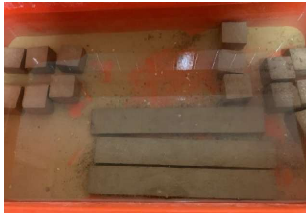
Imagen 21. Especímenes para flexión en el área de curado. Imagen propia.
