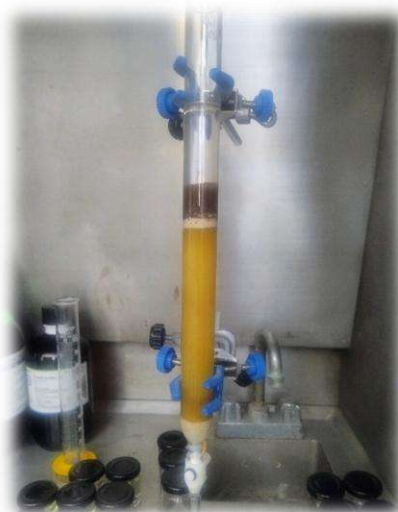
Figura 8. Montaje de la columna cromatográfica (foto tomada por el autor).
