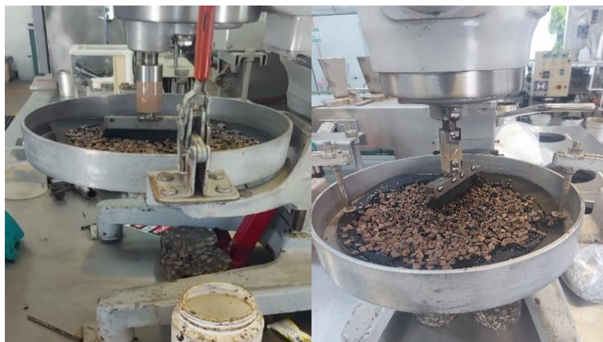
Imagen 3: Ensayo de sweep test de las muestras Fuente: elaboración propia
