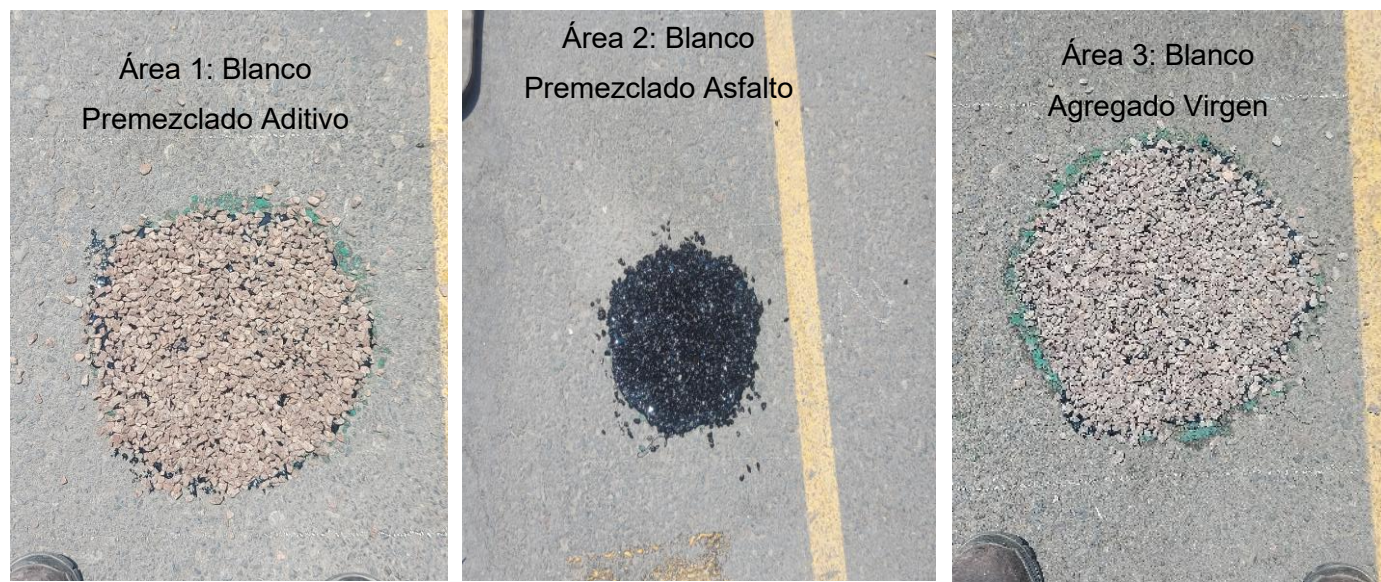
Imagen 5: Ensayo de permeabilidad para las condiciones de tratamiento por riego de sello pavimento.
