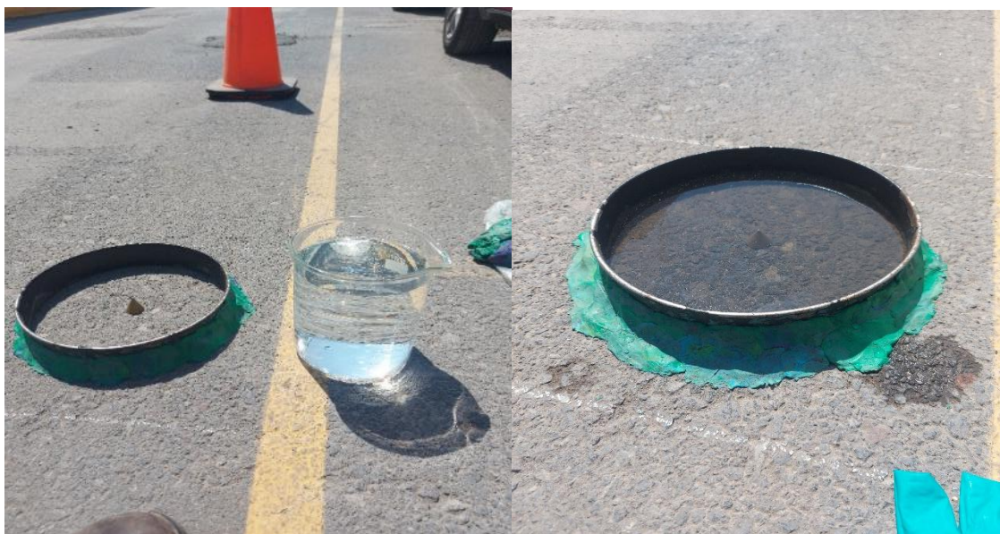
Imagen 4: Ensayo de permeabilidad para las condiciones iniciales del pavimento. Fuente: elaboración propia
