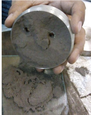
Figura 6-XVIII. Probeta de suelo después de la falla.
