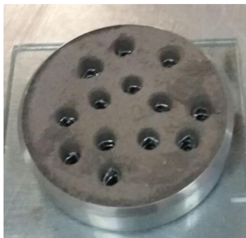
Figura 6-VIII. Probeta modificada con 13 perforaciones de 7 mm de diámetro.
