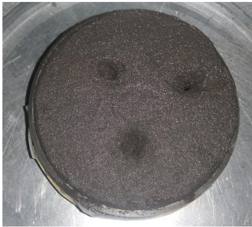
Figura 6-X. Probeta modificada con 3 perforaciones de 10 mm de diámetro.
