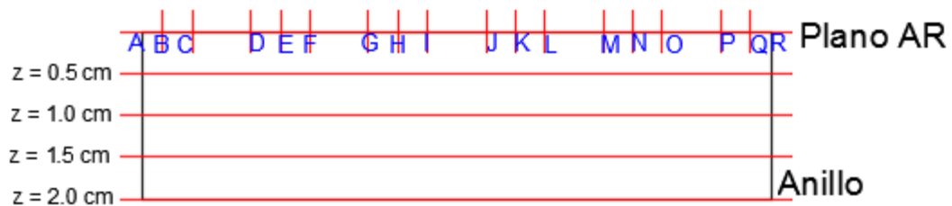
Figura 5-XV. Vista en corte del modelo considerado para el análisis de esfuerzos.
