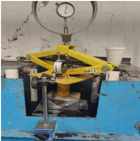
Figura 16. Imagen de la losa reticular y del ensaye de expansión en la misma.
