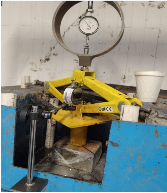
Figura 17. Imagen de la losa con retícula perimetral y del ensaye de expansión en la misma.
