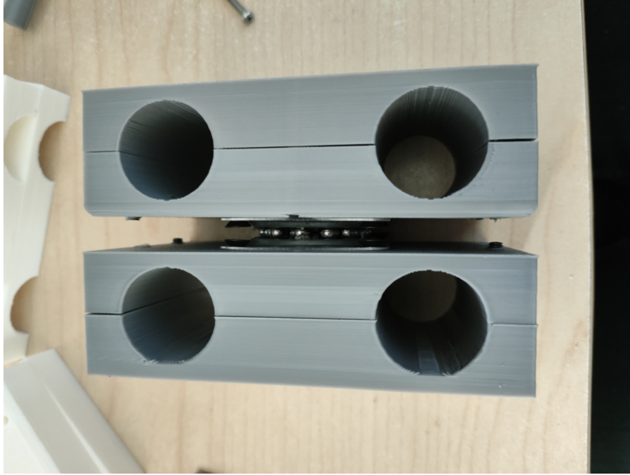
Figura 3.4: Pieza impresa para sujeción de actuadores y eslabones.
