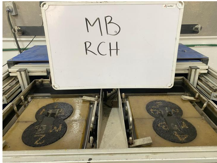
Figura 18 Muestra ensayada en equipo de Rueda Cargada de Hamburgo
