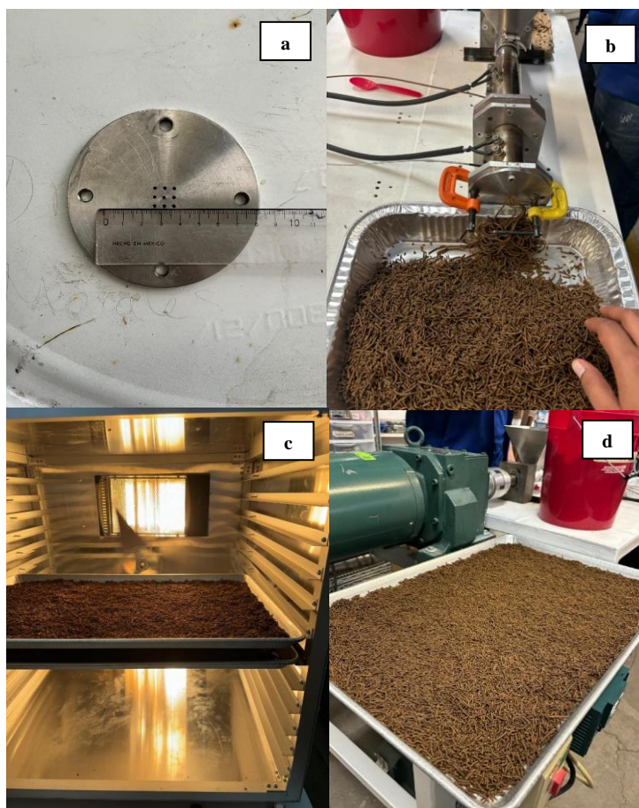
Ilustración 3. Fases de procesamiento de mezclas de harina para elaboración de dietas experimentales por extrusión, a) Dado utilizado para obtención de alimento con 2 mm de diámetro, b) extrusión de mezclas, c) secado de alimentos por deshidratados eléctrico, d) alimento obtenido
