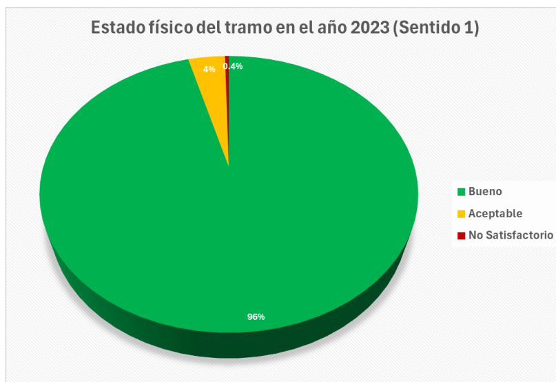
Figura 34. Estado físico por IRI del tramo en el año 2023 (Sentido 1).
