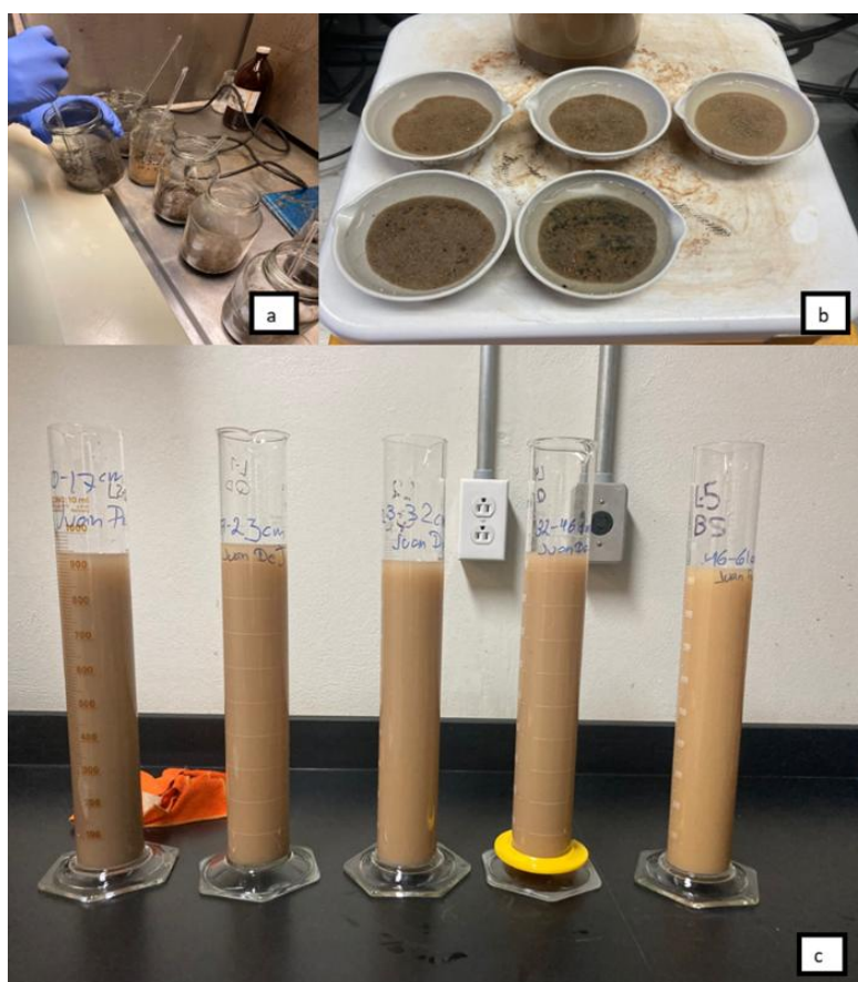
Figura 17. Determinación de la textura mediante el método del hidrómetro de Bouyoucos. a) fase de dispersión, b) partículas de arenas producto de la etapa de dispersión.
