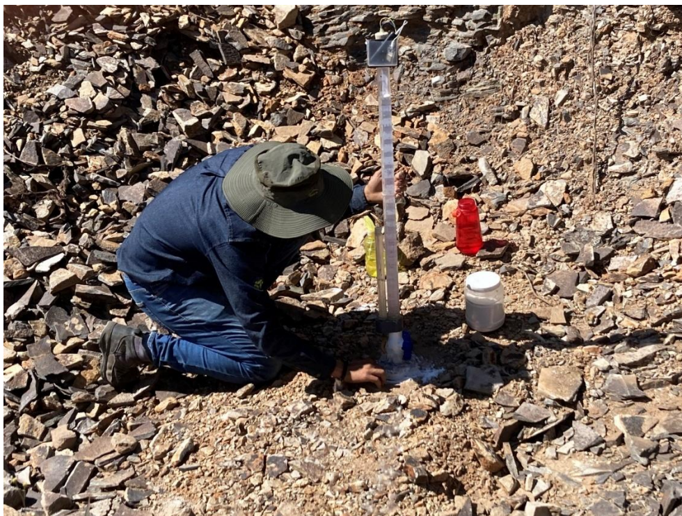
Figura 20. Establecimiento del infiltrómetro de tensión.
