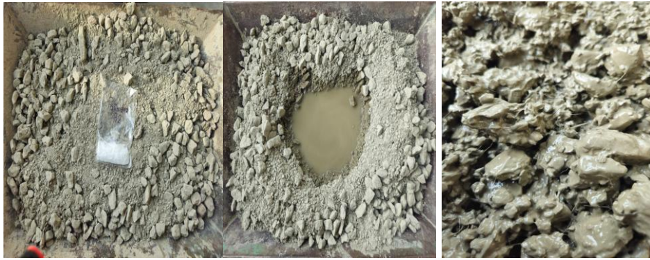
Figura 4.3.3. Proceso de mezcla de los materiales con el polímero FIBRAFEST.
