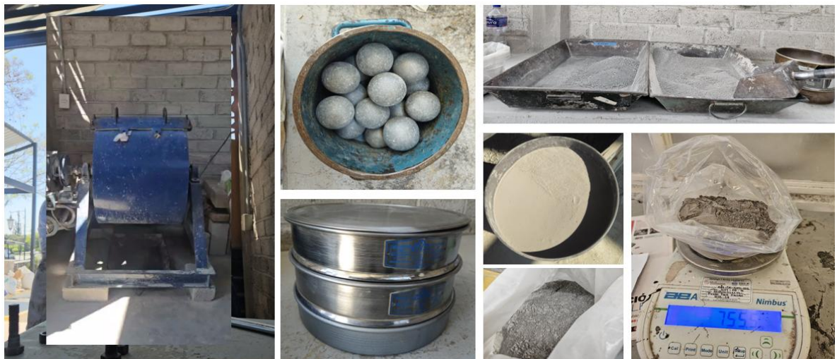
Figura 4.1.4.1. Imagen del micro-material antes y después del triturado en la máquina de Desgaste de los Ángeles.
