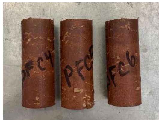
Figura 117. Probetas de fibra de caña – PFC para prueba de compresión (2025).
