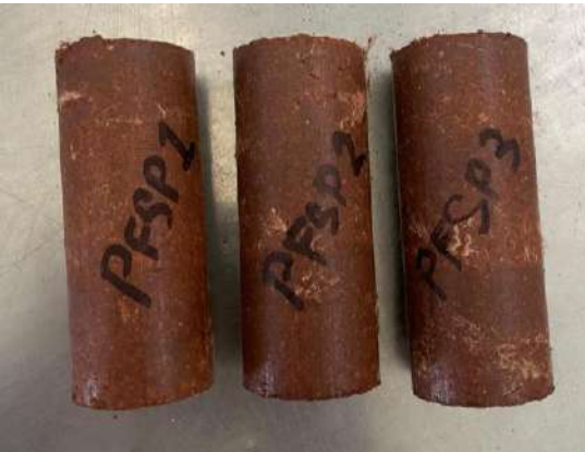
Figura 110. Probetas de polipropileno – PFSP para prueba de tensión (2025).
