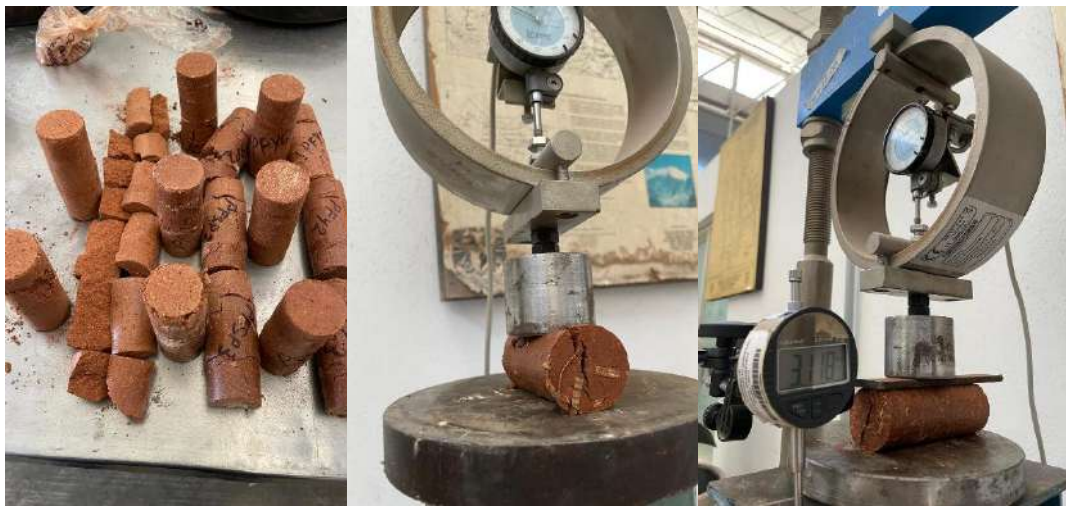
Figura 126. Corte de probetas en esfuerzo máximo- prueba de tensión: RF-PFSP-PFY-PFP (2025).
