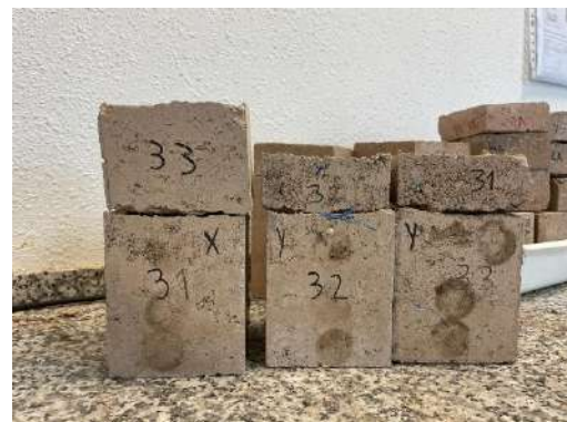
Figura 106. Tongada de tapial reforzada con fibra malla de vidrio – M10 (2024).
