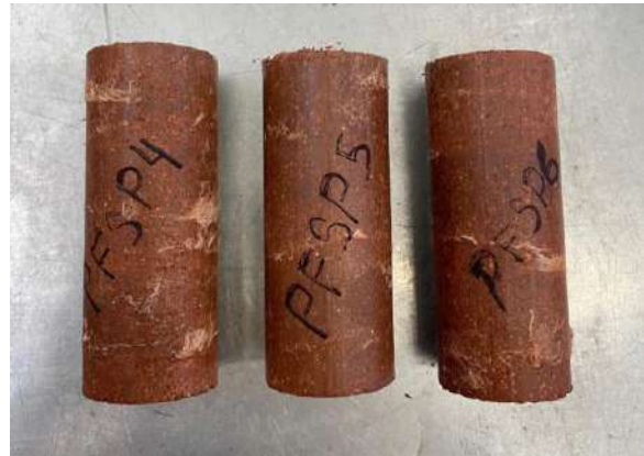
Figura 109. Probetas de polipropileno - PFSP para prueba de compresión simple (2025).
