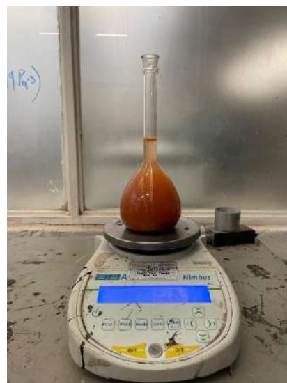
Figura 81. Peso de matraz con suelo aforado (2025).
