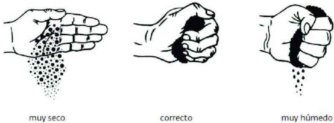
Figura 15. Prueba del puño (2020).
