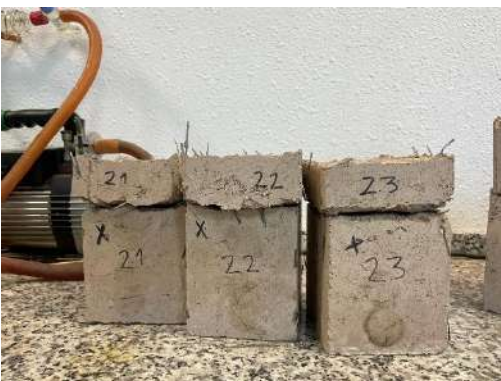
Figura 107. Tongada de tapial reforzada con fibra plástica – F48 (2024).
