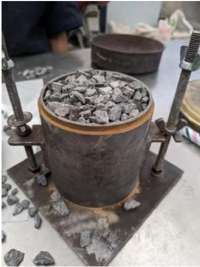
Figura 98. Prueba de peso volumétrico seco compacto (2025).
