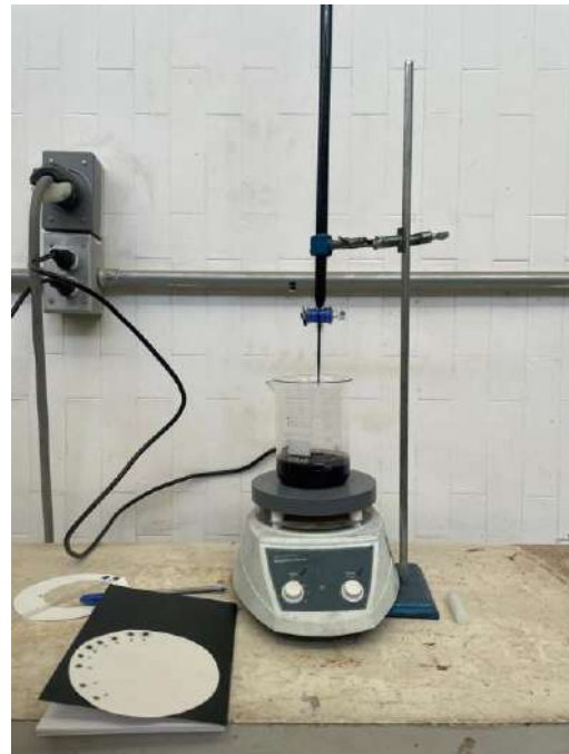
Figura 83. Azul de metileno en bureta (2025).
