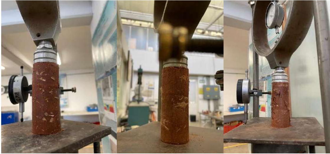
Figura 125. Deformación de probetas en esfuerzo máximo- prueba de compresión simple (2025).
