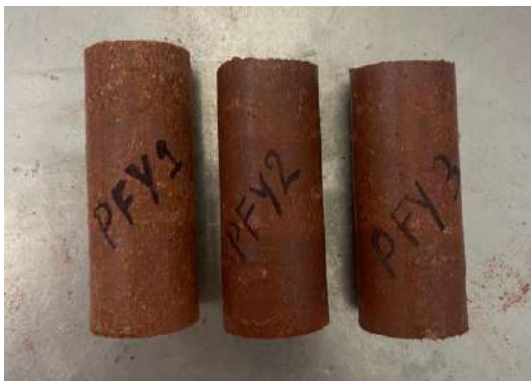
Figura 120. Probetas de fibra de yute– PFY para prueba de tensión (2025).
