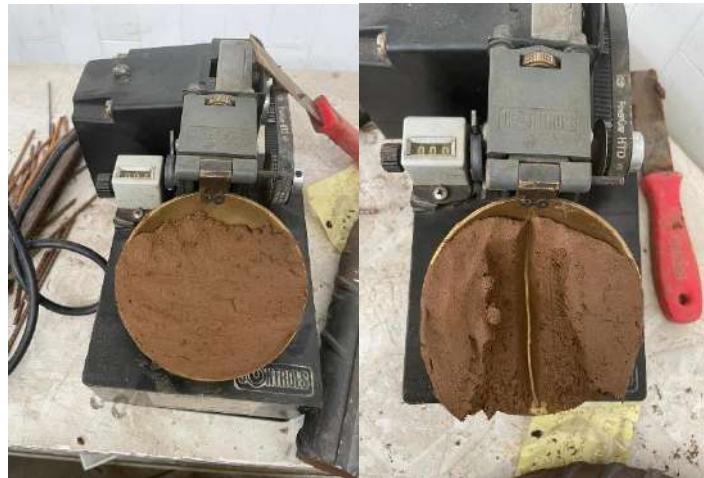
Figura 78. Prueba de LL en copa de Casagrande SOJ (2024).
