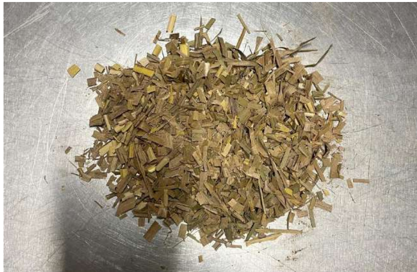
Figura 101. Fibra de caña de 1.2 cm de longitud (2025).
