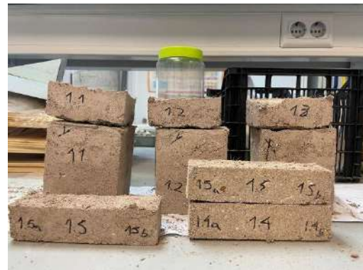
Figura 104. Tongada de tapial reforzada con fibra malla de vidrio-F12 (2024).
