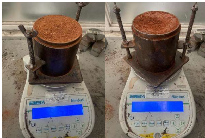
Figura 86. Peso de segunda capa de compactación Proctor SOJ (2025).
