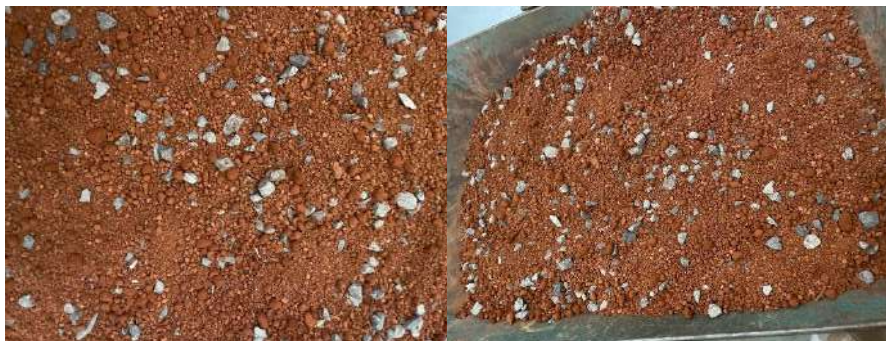
Figura 58. Mezcla de materiales para BTC sin refuerzo- referencia (2025).
