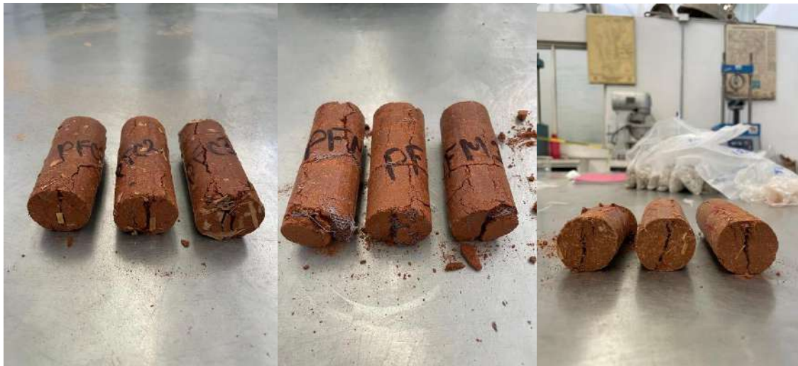
Figura 127. Corte de probetas en esfuerzo máximo- prueba de tensión: PFC-PFM-PFYP (2025).
