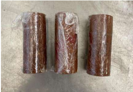
Figura 122. Probetas de fibra de yute + palma PFYP para prueba de tensión (2024).
