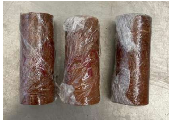
Figura 121. Probetas de fibra de yute + palma PFYP para prueba de compresión (2024).
