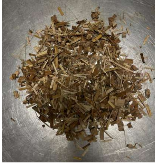
Figura 100. Fibra de palma de plátano de 1.2 cm de longitud (2025).
