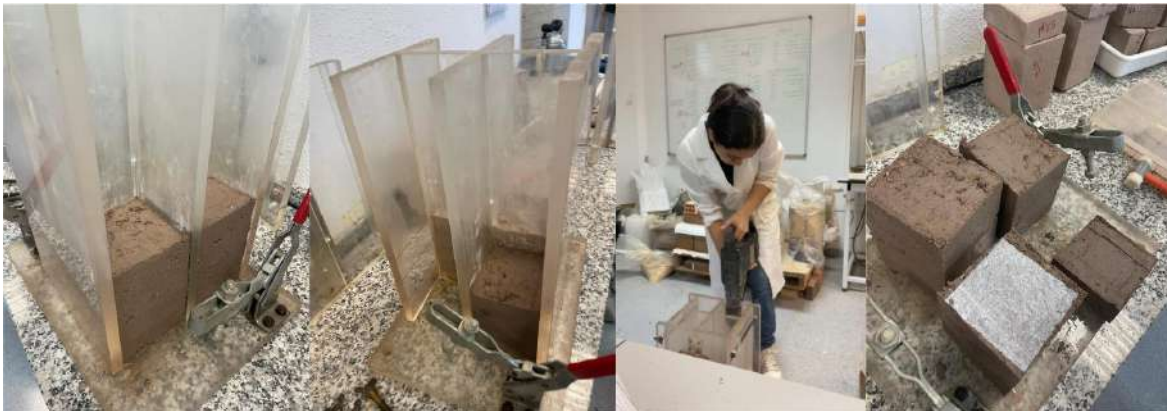
Figura 143. Compactación de probetas de tapial por medios mecánicos (2024).
