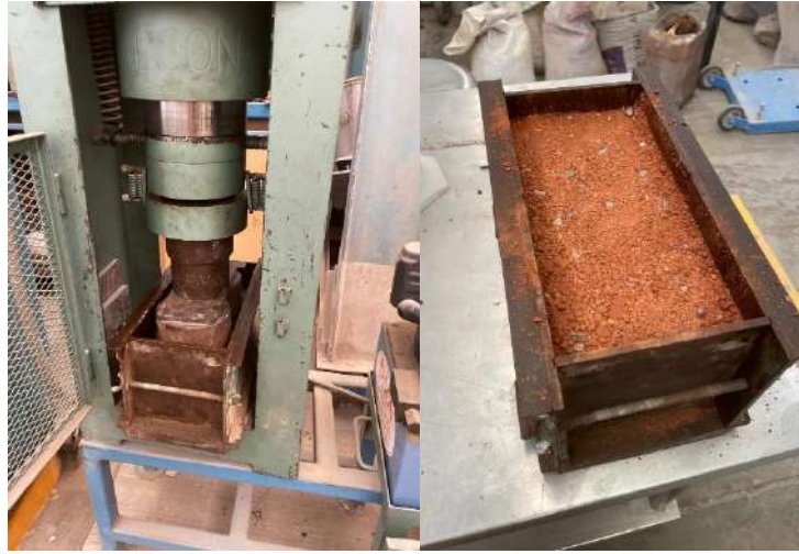
Figura 61. Compactación de mezcla de BTC (2025).
