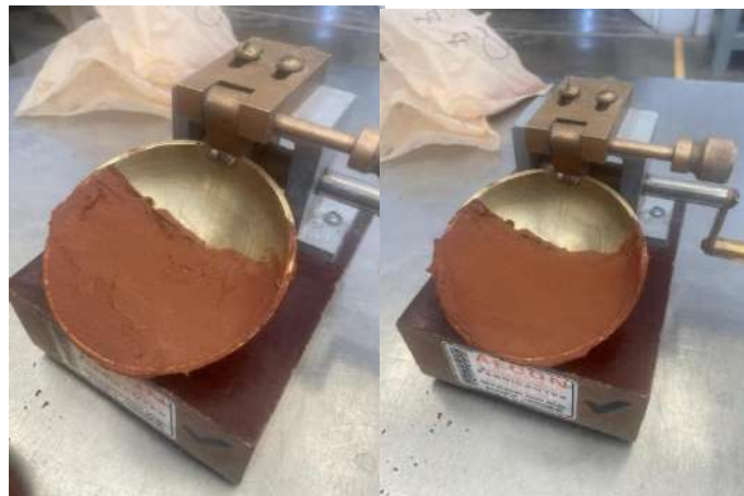
Figura 73. Prueba de LL en copa de Casagrande STO (2024)
