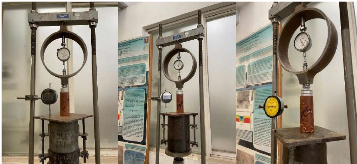
Figura 123. Prueba de compresión simple en probetas de tapial (2025).
