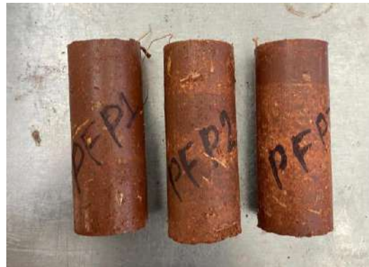
Figura 115. Probetas de fibra de palma – PFP para prueba de compresión (2025).
