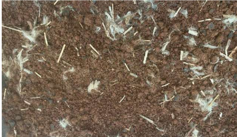
Figura 129. Reforzamiento de mezcla con fibra de yute y palma (2025).
