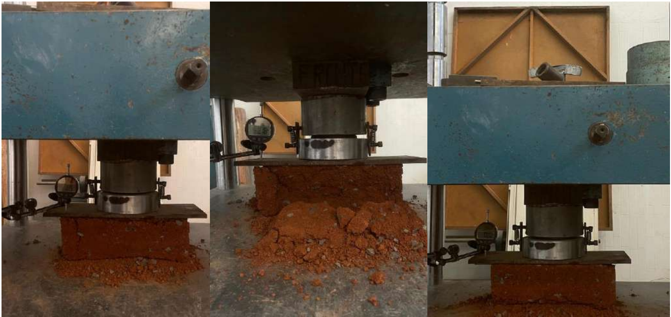
Figura 66. Prueba de resistencia a la compresión en BTC sin refuerzo (2025).
