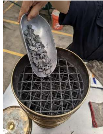
Figura 97. Granulometría de agregado grueso (2025).
