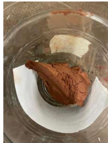
Figura 74. Extracción de STO de la copa de Casagrande para LL (2024).
