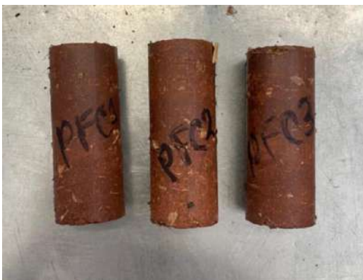
Figura 118. Probetas de fibra de caña – PFC para prueba de tensión (2025).
