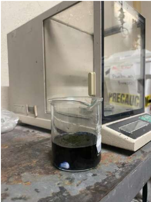
Figura 84. Preparación del azul de metileno (2025).
