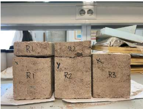
Figura 105. Tongada de tapial reforzada con fibra plástica- Ref. (2024).
