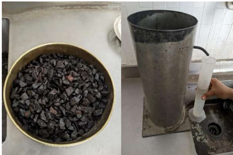
Figura 96. Prueba de densidad y absorción de agregado grueso (2025).
