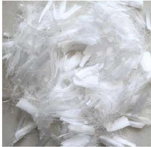
Figura 102. Fibra de polipropileno M-12 Sika (2025).
