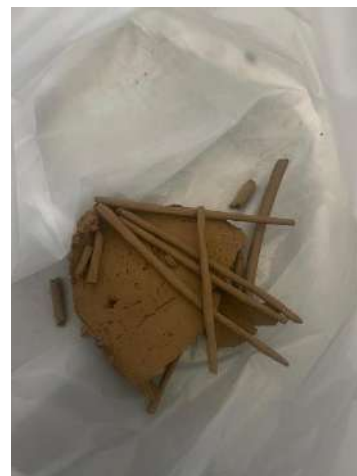
Figura 76. Extracción de SOJ de la copa de Casagrande para LL (2024).
