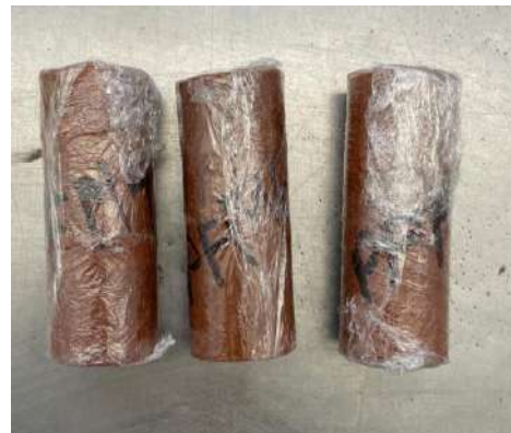
Figura 113. Probetas de fibra malla - PFM para prueba de compresión simple (2025).
