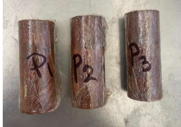
Figura 111. Probetas de referencia – RF para prueba de compresión simple (2025).
