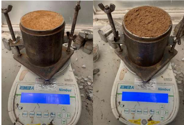
Figura 87. Peso de segunda capa de compactación Proctor SOJ (2025).
