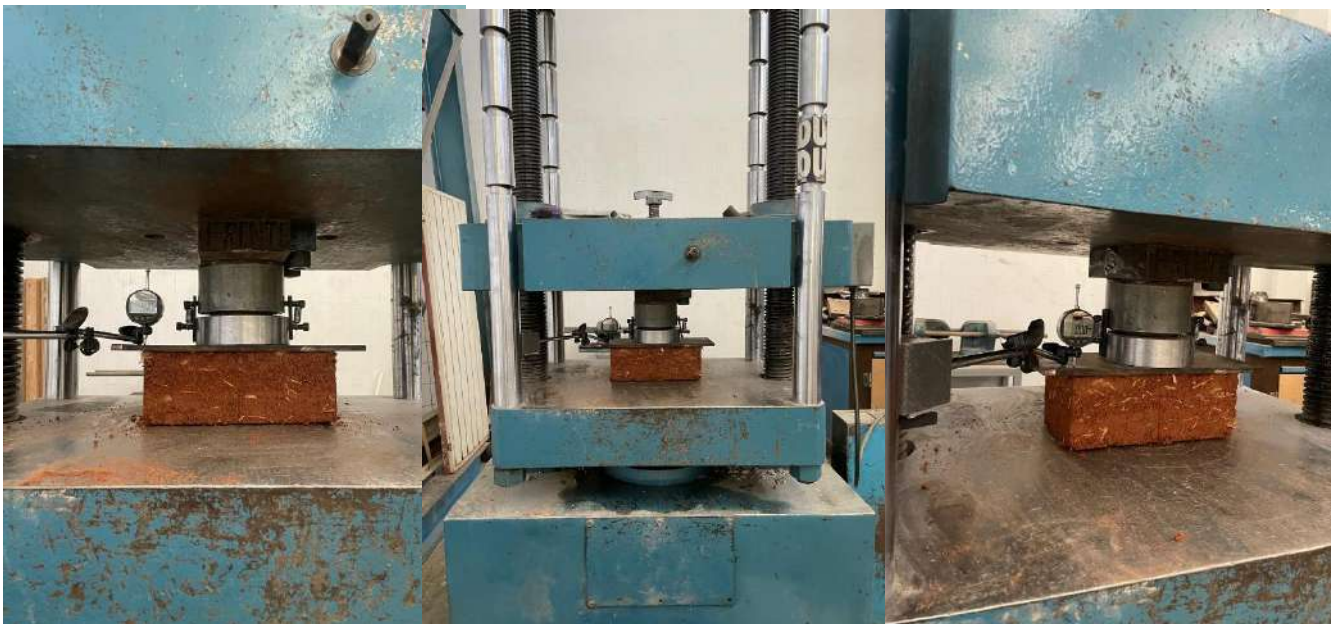
Figura 67. Prueba de resistencia a la compresión en BTC con refuerzo de fibra (2025).
