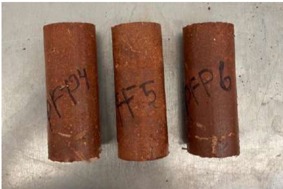
Figura 116. Probetas de fibra de palma – PFP para prueba de tensión (2025).
