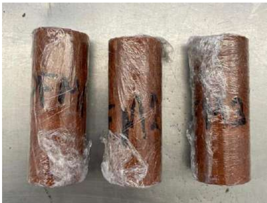
Figura 114. Probetas de fibra malla - PFM para prueba de tensión (2025).
