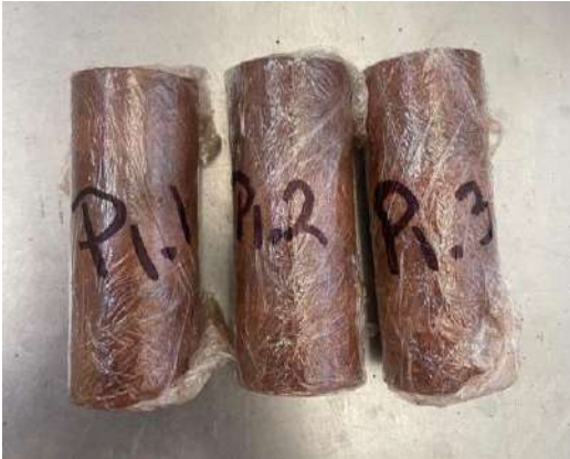
Figura 112. Probetas de referencia – RF para prueba de tensión (2025).
