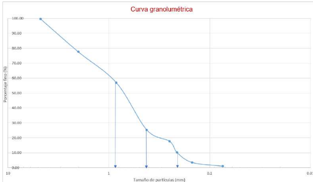
Figura 70. Curva granulométrica del STO (2024).
