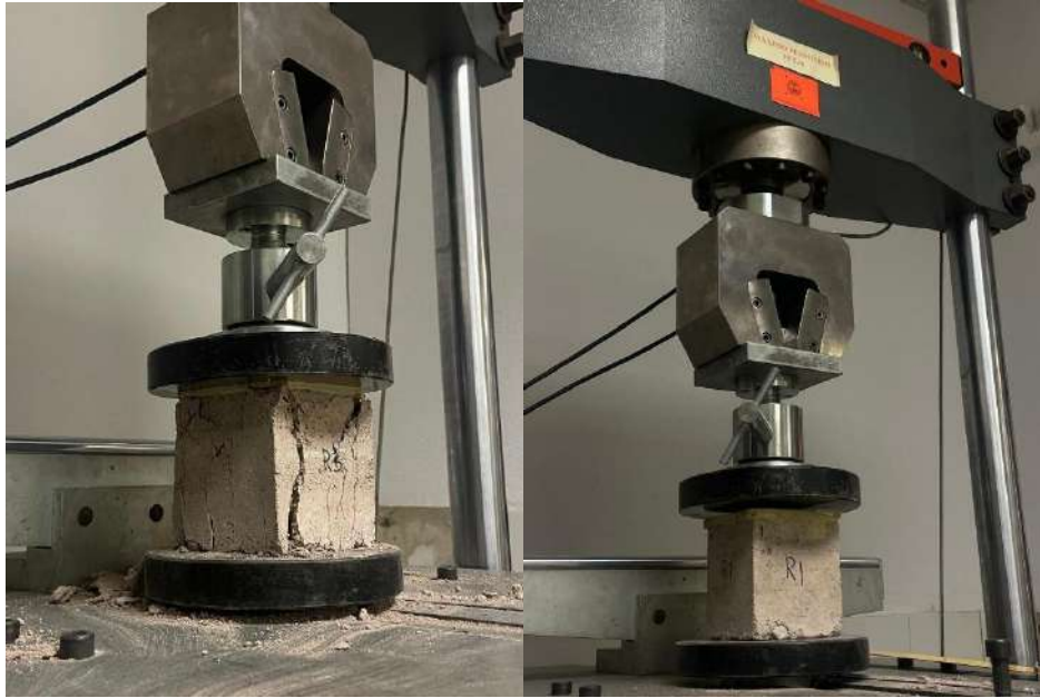
Figura 34. Ensayo de compresión en muestras de tapial (2024).
