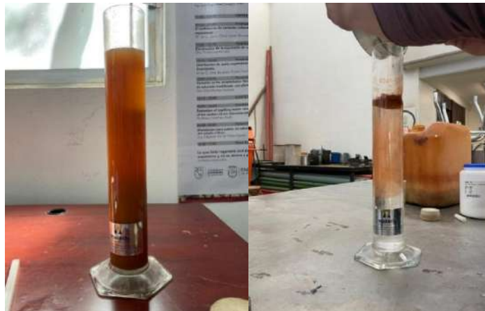
Figura 72. Ensayo de hidrómetro (2024).
