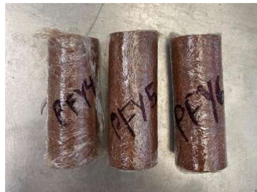
Figura 119. Probetas de fibra de yute– PFY para prueba de compresión (2025).
