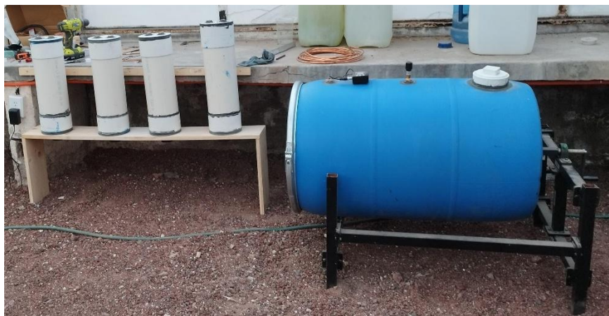
Figura 20. Implementación del biodigestor y sus filtros
