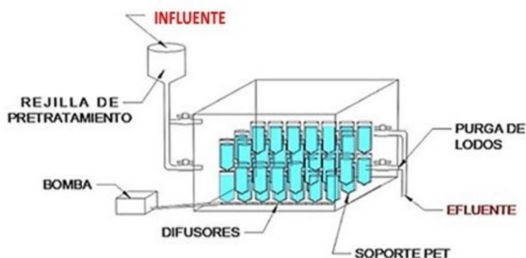
Figura 3. Esquema de reactor biológico (Zúñiga-Hernández et al., 2023)
