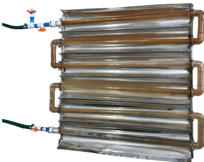
Figura 10. Sistema foto-Fenton utilizado para la remoción de LNG en agua residual doméstica.
