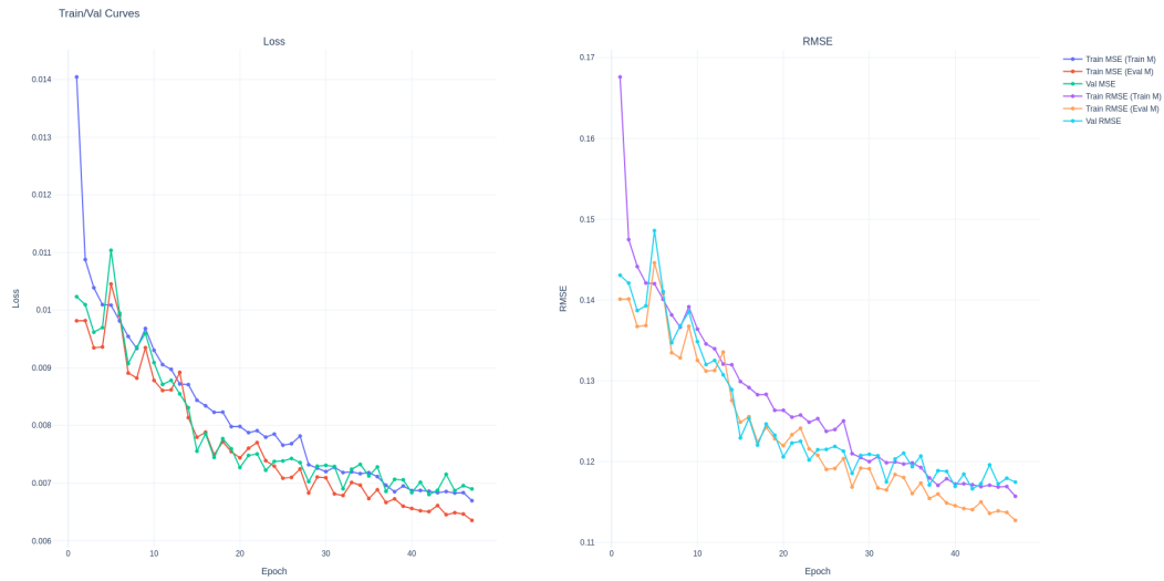
Figura 27: Curvas de entrenamiento y validación del modelo BiLSTM (pérdida Huber y RMSE) para el mejor fold.
