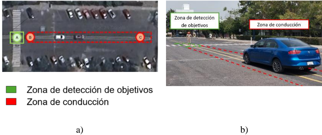
Figura 31: a) Pista de pruebas acondicionada para validación del sistema EWA y b) ejemplo real de escenario de prueba con clase “Peatón”.
