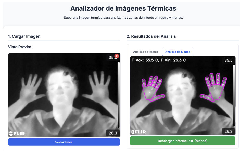
Figura 27: Resultado mostrado tras el envío de una imagen para su segmentación y análisis térmico (autoría propia).
