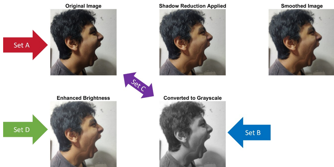
Figura 10. Diferentes etapas del procesamiento de imágenes: Set A) conjunto de imágenes crudas; Set B) conjunto de imágenes procesadas; Set C) conjunto híbrido; Set D) conjunto de imágenes semiprocesadas.
