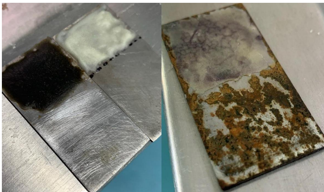
Figura 20. Placa de acero 1018 con recubrimiento antes y después de ser expuesta al ambiente corrosivo.
