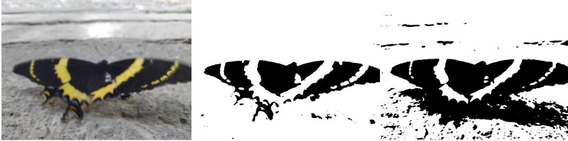
Figura 10 Ejemplo de umbralización a 2 niveles diferentes (64 y 128).
