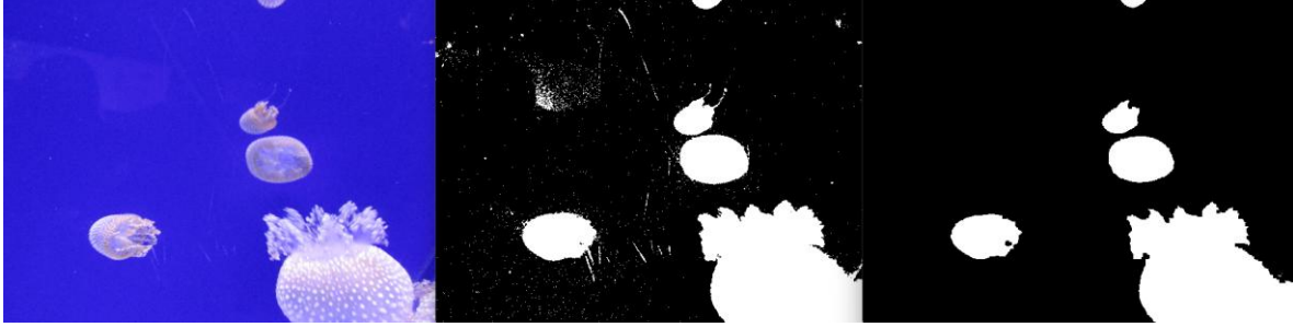
Figura 13 Ejemplo de binarización y erosión.
