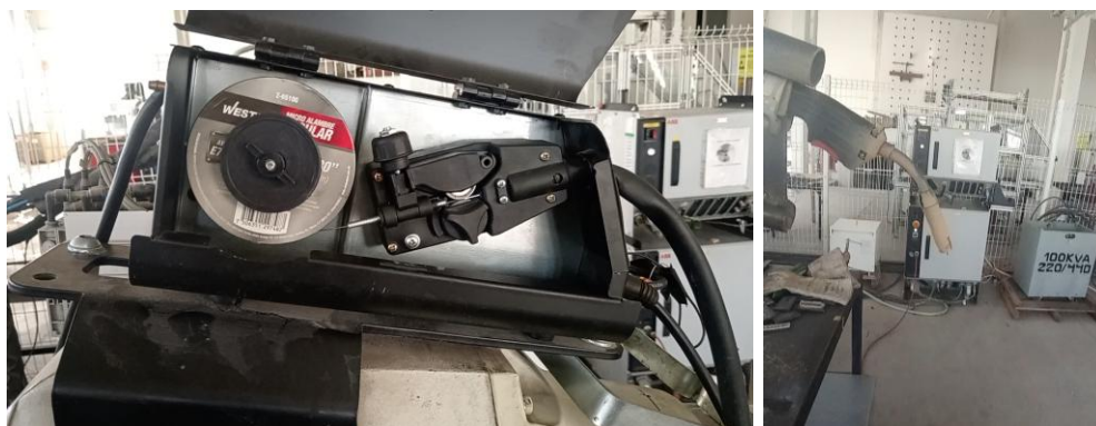
Figura 27 Sistema de alimentado de micro alambre de maquina VOL-MIG110
