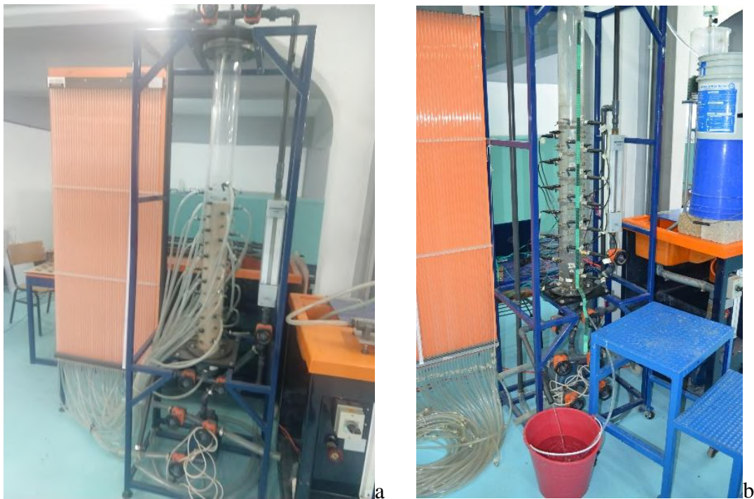
Figura 1.1.- Foto del equipo de Columna de Filtración con Lecho Profundo Armfield - W5-MkII-A, ubicado en el laboratorio de fluidos de la UAQ. A) Condiciones iniciales, conectados con piezómetros de manguera. B) Adecuado con los transductores de presión.
