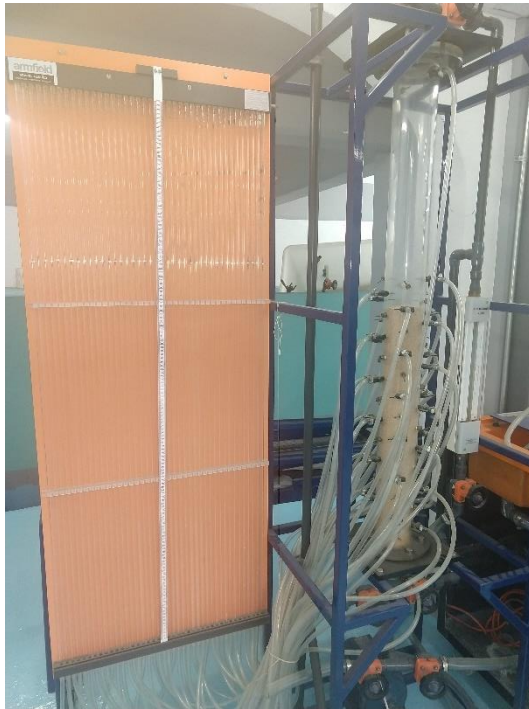
Figura 9. Foto del equipo de Columna de Filtración con Lecho Profundo Armfield - W5-MkII-A, ubicado en el laboratorio de fluidos de la UAQ. Condiciones iniciales, conectados con piezómetros de manguera, General
