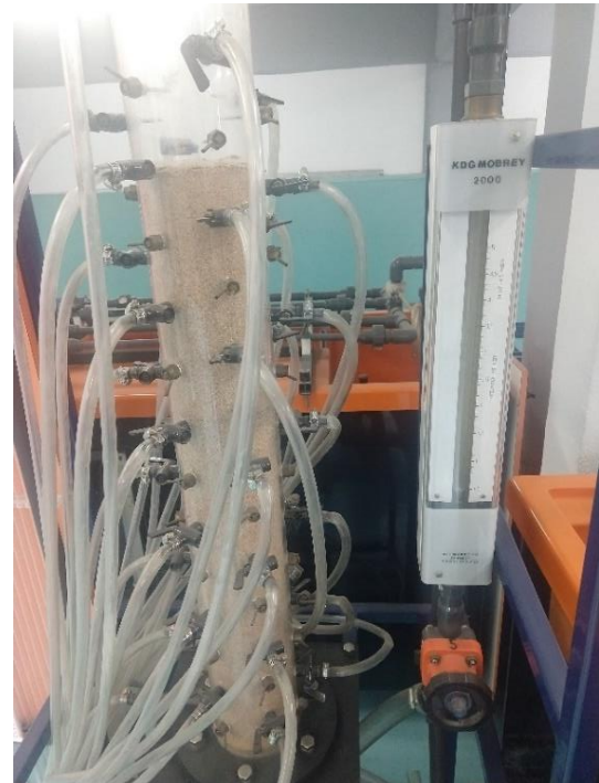
Figura 10. Foto del equipo de Columna de Filtración con Lecho Profundo Armfield - W5-MkII-A, ubicado en el laboratorio de fluidos de la UAQ. conexiones iniciales antes de modificarlo.
