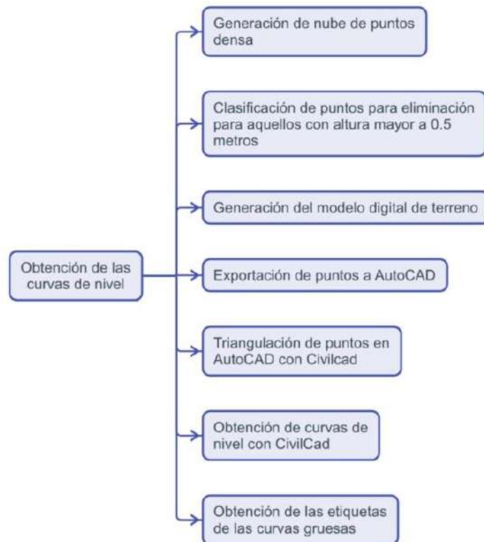
Figura 19. Proceso de obtención de curvas de nivel.
