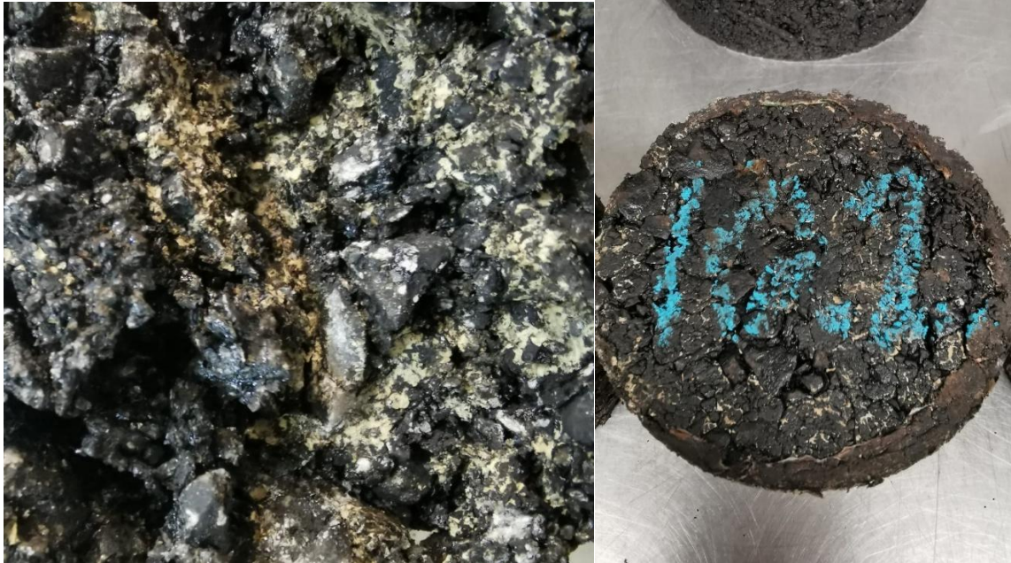
Figura 4.4.13. Especimen elaborado con LDPE
