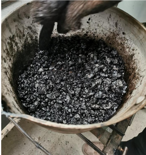
Figura 4.4.3 Mezclado de agregado pétreo, asfalto y residuo plástico Fuente: Elaboración propia
