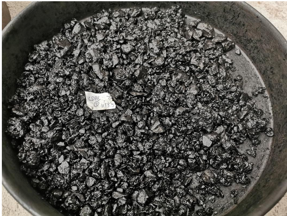
Figura 4.4.4 Identificación de mezcla para curado en horno Fuente: Elaboración propia
