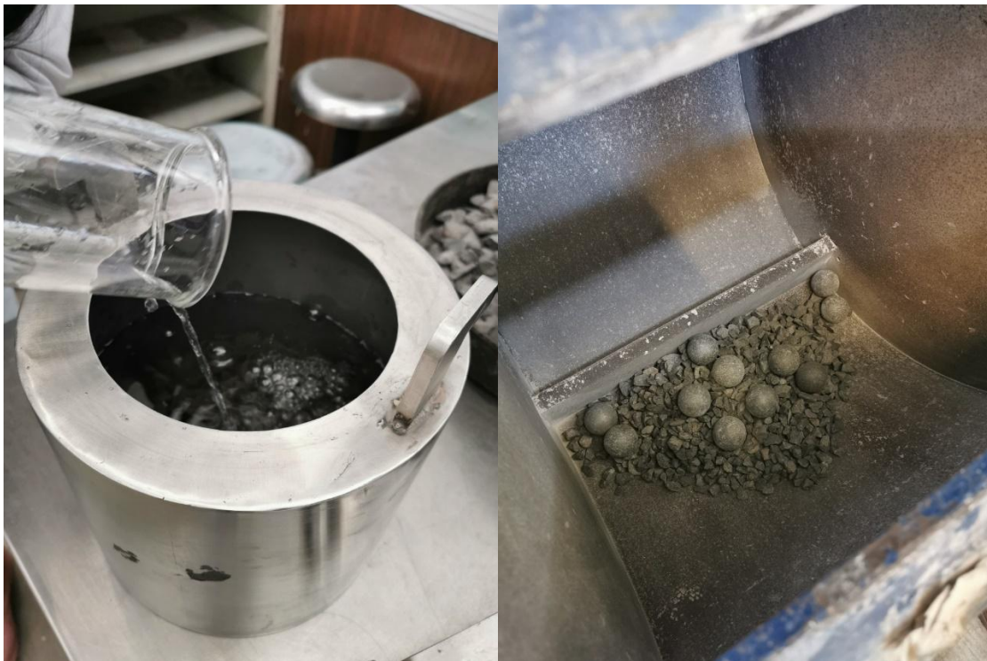
Figura 4.2.6. Ensayes desgaste microdeval y desgaste de los ángeles
