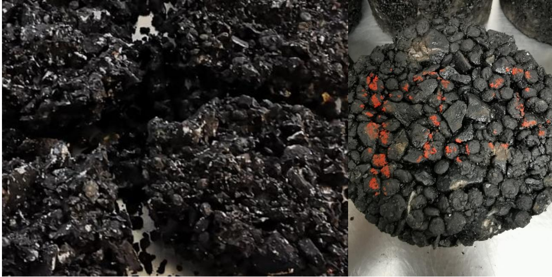
Figura 4.4.14. Espécimen elaborado con PP
