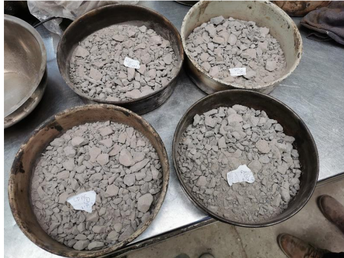
Figura 4.4.1 Separación y pesada de agregados para lograr granulometría Fuente: Elaboración propia
