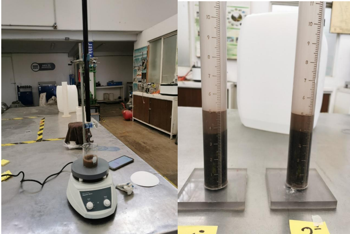
Figura 4.2.7. Ensayes Azul de metileno y equivalente de arena
