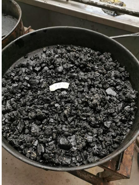
Figura 4.4.12. Mezclado de agregado, asfalto y residuos plásticos Fuente: Elaboración propia
