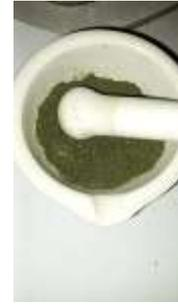
*Ilustración 4. Proceso de molienda de muestras en mortero.*
