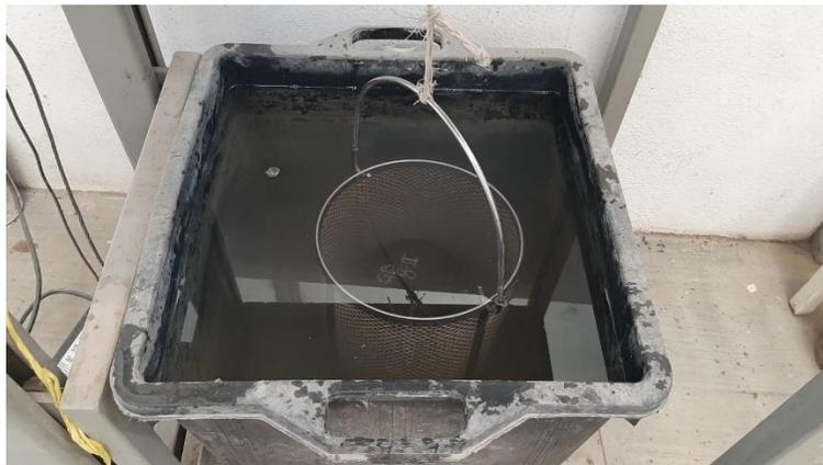
*Figura 15. Determinación de peso sumergido de especímenes Marshall.*
