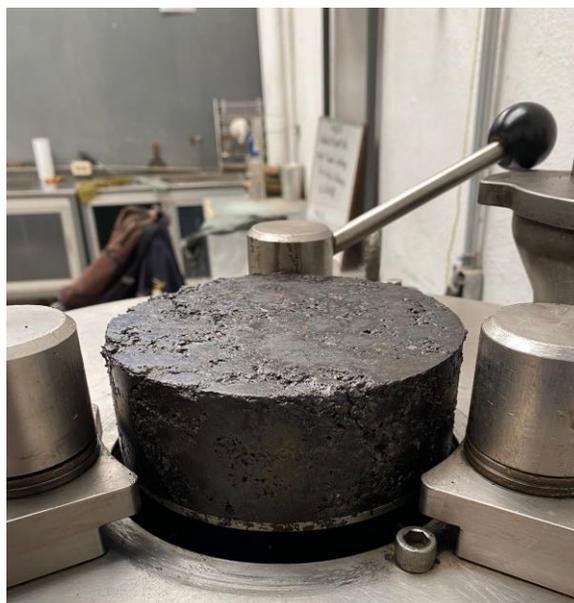
*Figura 24. Espécimen para prueba de rueda cargada de Hamburgo compactado mediante compactador giratorio.*
