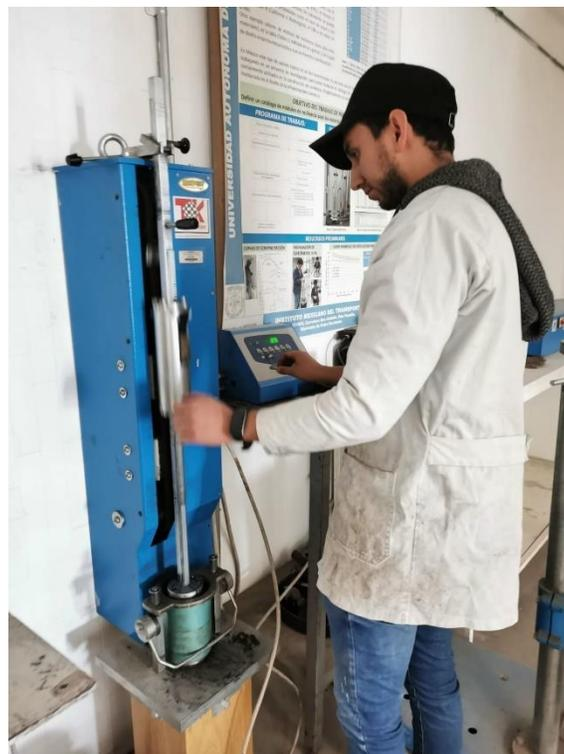
*Figura 13. Proceso de compactación mezcla asfáltica usando martillo Marshall.*
