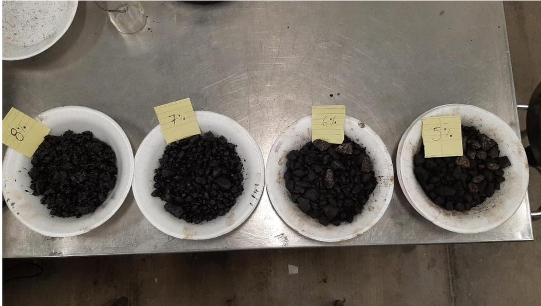
*Figura 11 Resultado de las pruebas de cubrimiento del agregado.*
