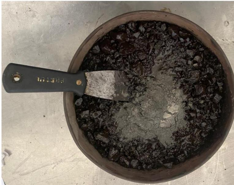
*Figura 22. Proceso de incorporación de rellenos cementantes a la mezcla.*
