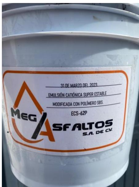
*Figura 9. Emulsión asfáltica ECS-6*
