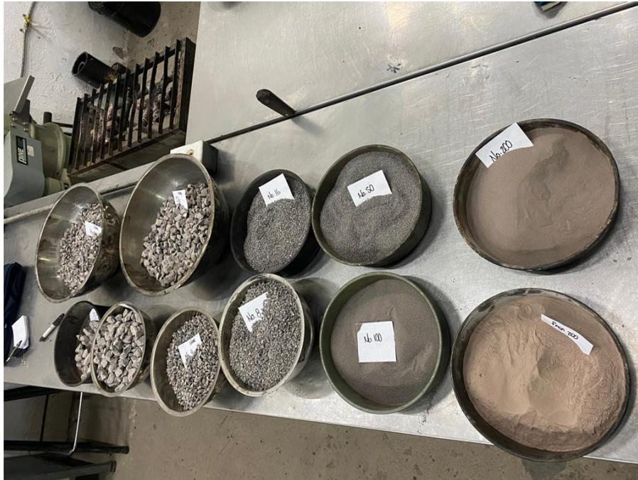
*Figura 20. Agregados cribados y clasificados por su tamaño.*
