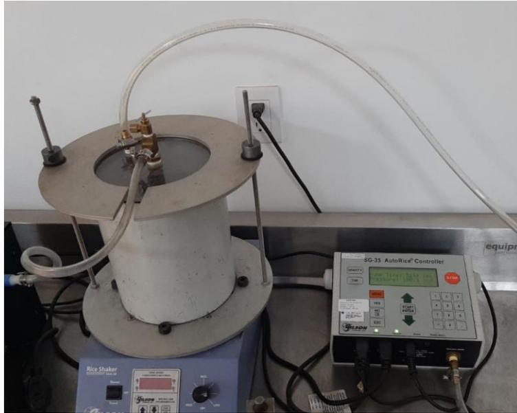
Figura 17. Proceso de saturación de las muestras con bomba de vacíos.
