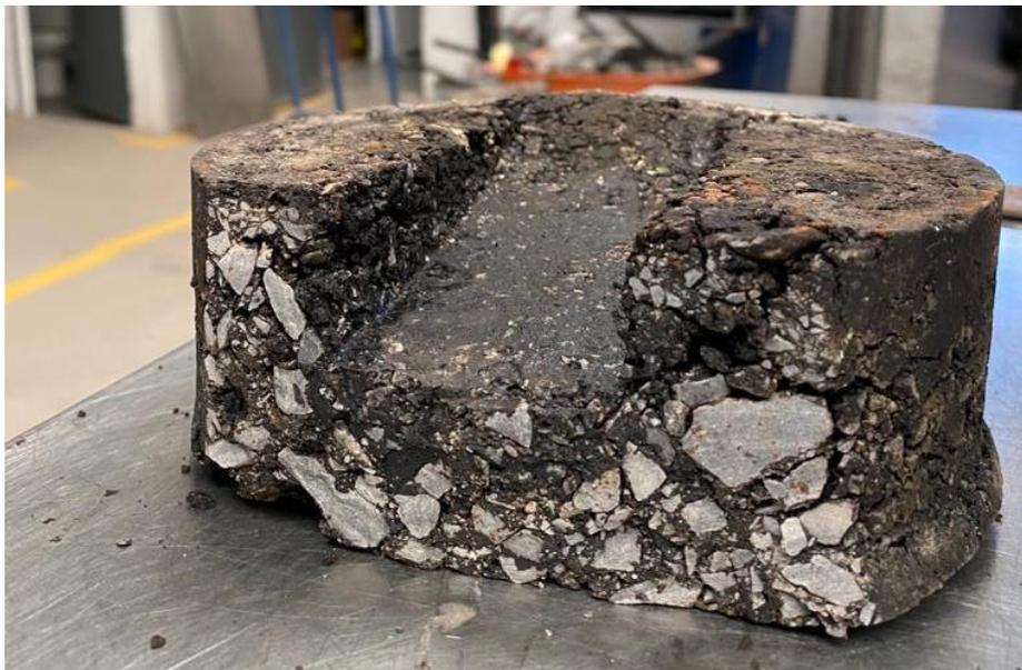
Figura 34. Formación de rodera en espécimen ensayado.
