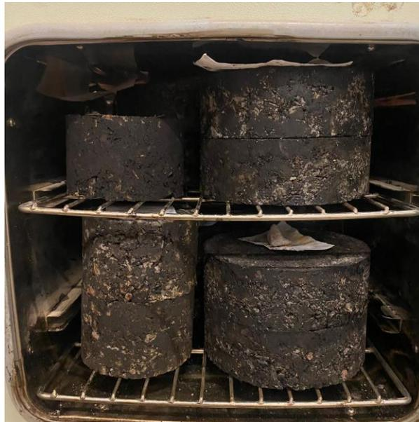
*Figura 25. Curado de mezcla asfáltica en horno de secado.*
