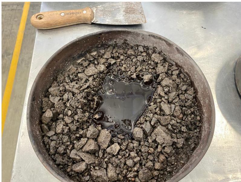
*Figura 21. Proceso de incorporación de fase líquida a la mezcla.*
