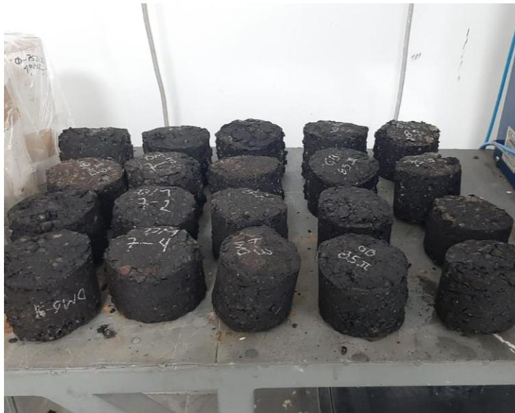
Figura 18. Especímenes luego de ser sometidos a las pruebas de estabilidad y flujo.
