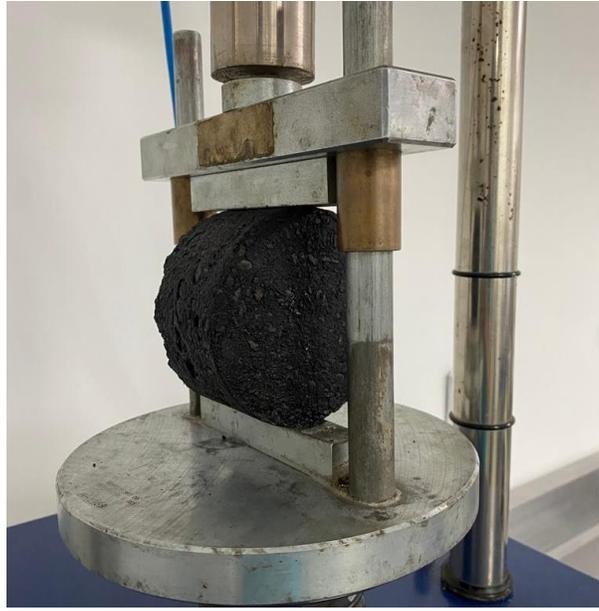
*Figura 29. Ensayo de tensión indirecta (TSR)*
