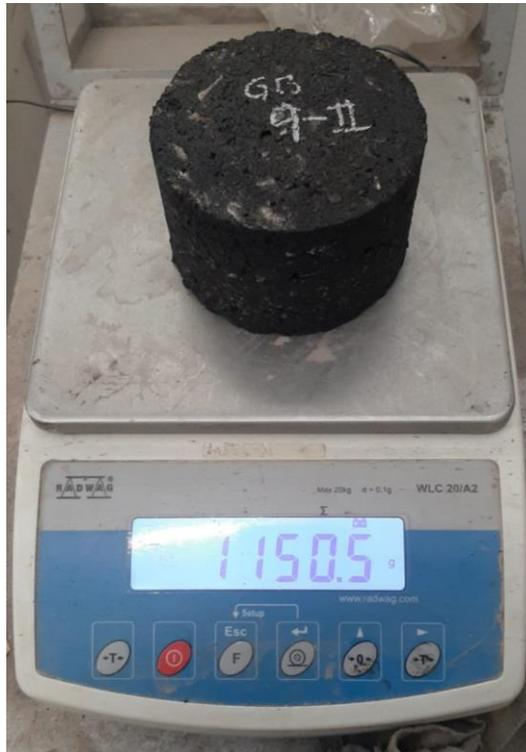
*Figura 14. Determinación de peso seco al aire de la pastilla luego de curado*
