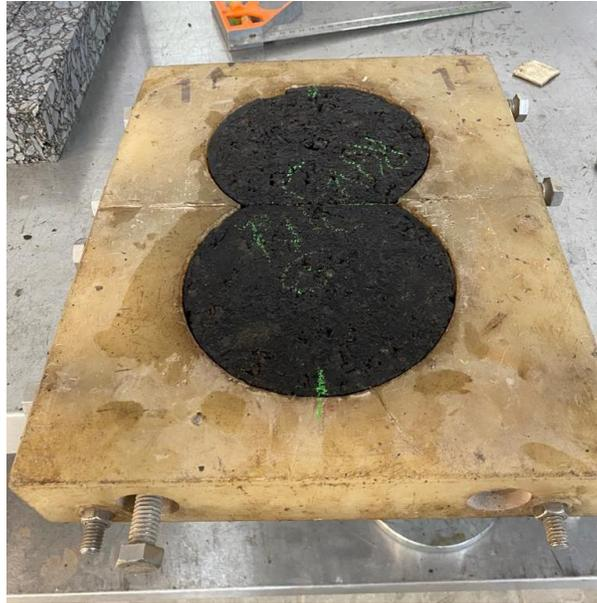
*Figura 30. Colocación de especímenes de rueda cargada*
