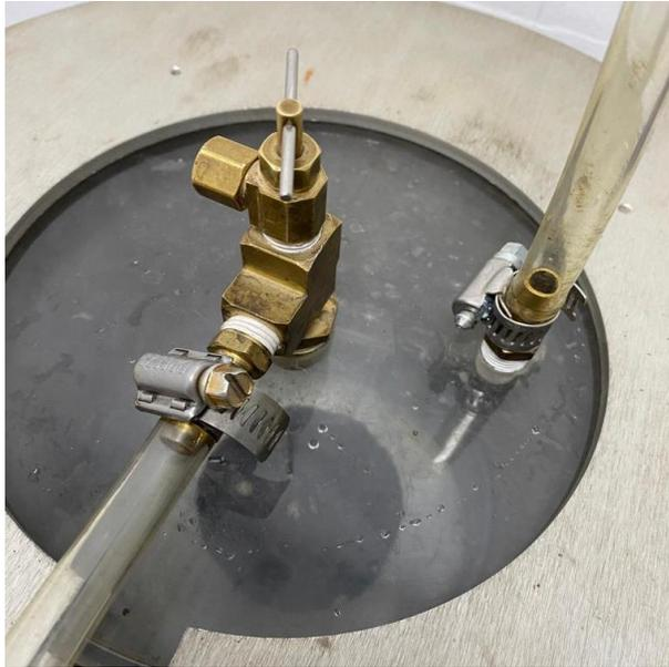
*Figura 26. Proceso de saturación de vacíos con agua y presión de vacío.*
