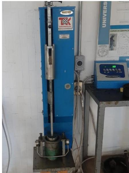
*Figura 23. Compactación de especímenes para TSR mediante compactador Marshall.*
