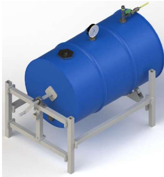
Figura 19. Parte frontal de Biodigestor (Fuente propia)
