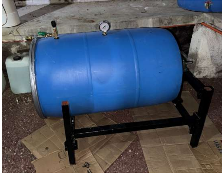
Figura 23. Biodigestor montado (Fuente propia)
