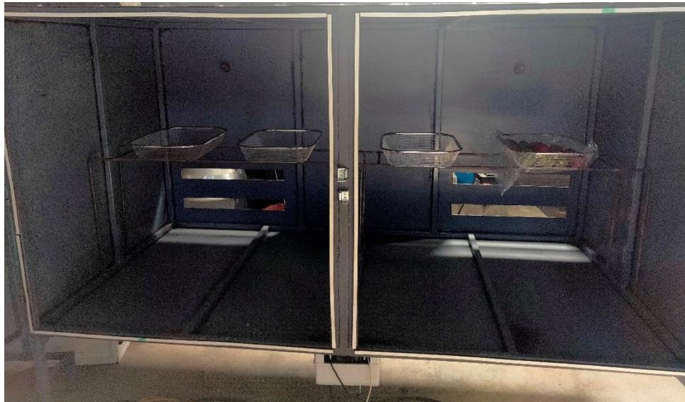
*Figura 30. Charolas colocadas dentro del deshidratador para prueba de secado.*
