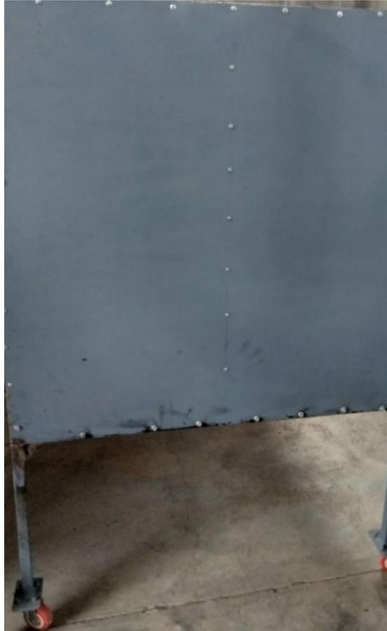
*Figura 17. Vista lateral del deshidratador con las láminas colocadas con pijas.*
