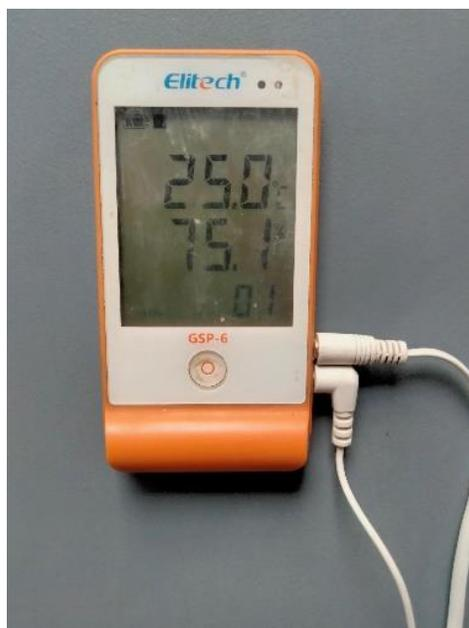
*Figura 31. Registrador de datos GSP-6 de temperatura y humedad marca Elitech.*
