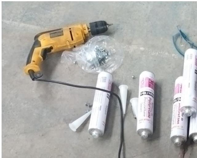
*Figura 16. Material utilizado: taladro, pijas de 3/4 de pulgada y silicón de alta temperatura.*
