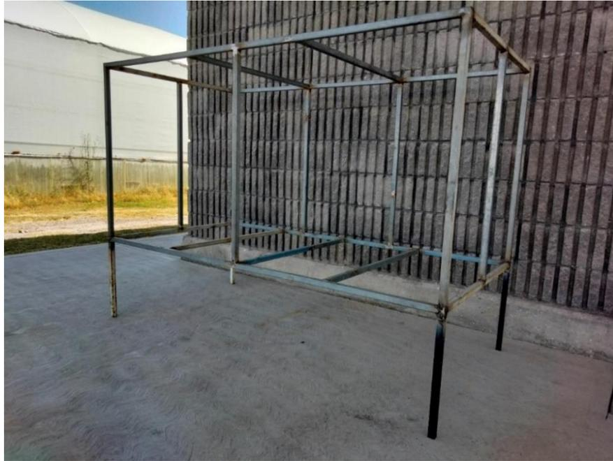
*Figura 15. Vista frontal isométrica de la estructura mecánica del deshidratador.*
