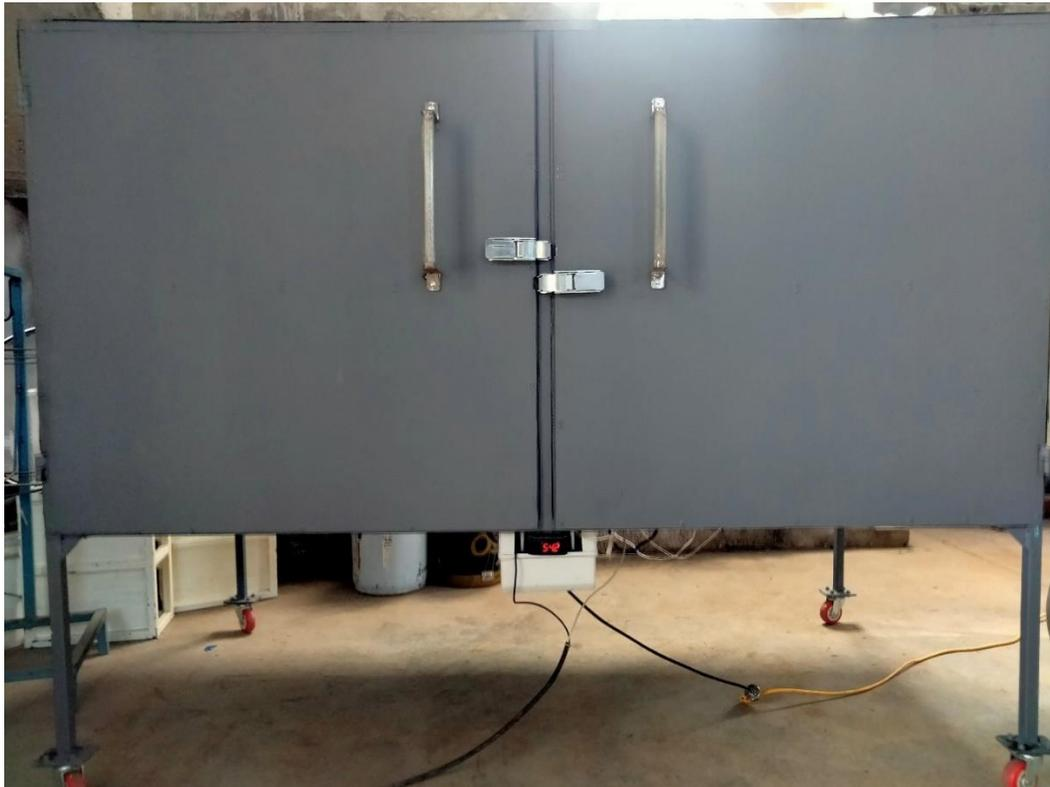
*Figura 38. Prototipo de deshidratador de bandejas para jitomate.*
