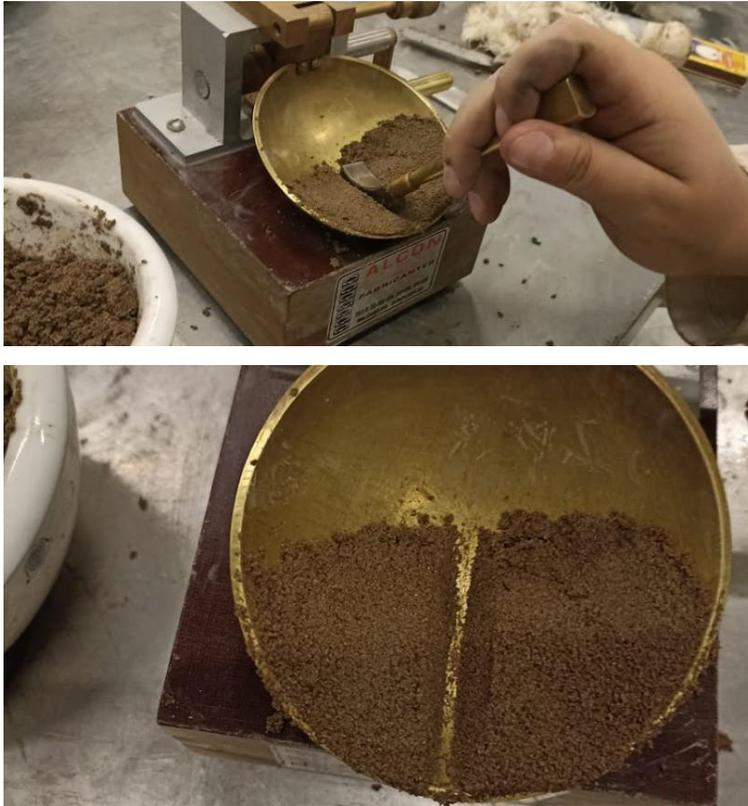
Figura 34: Intento de prueba de Copa de Casagrande.
