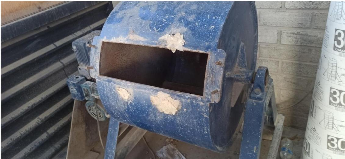
Figura 27: Equipo para prueba de desgaste de los Ángeles
