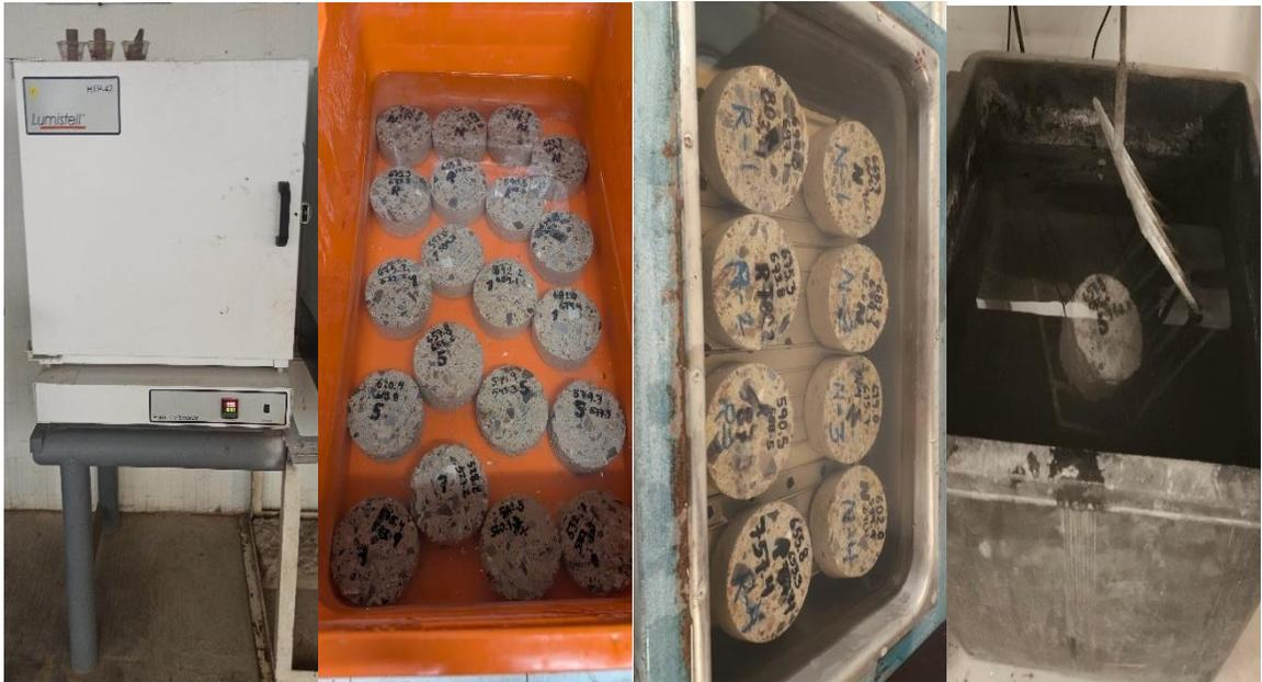
Figura 54: Procesos de secado, saturado, hervido e inmersión de las pastillas.
