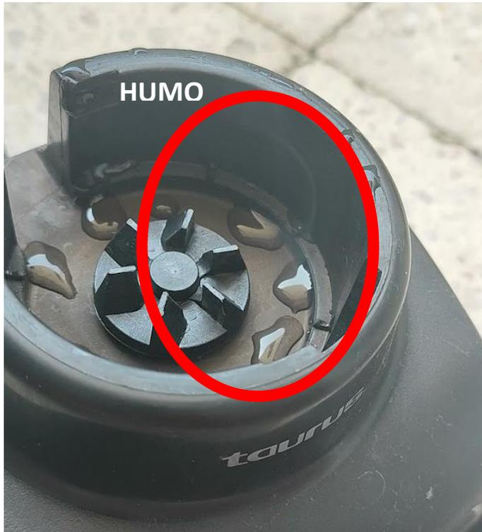
Figura 14: Motor de licuadora dañado
