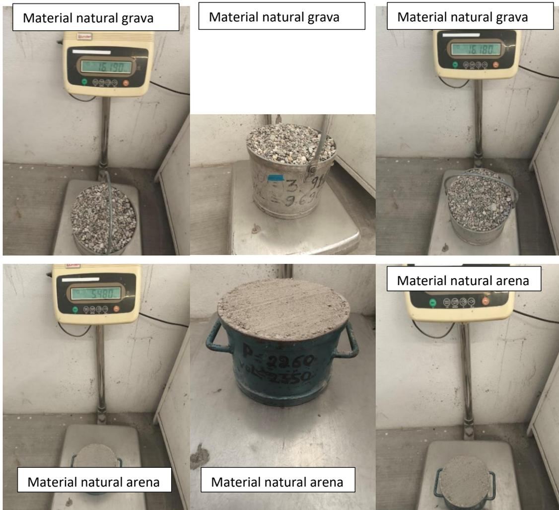
Figura 22: Mediciones de peso unitario y vacíos de grava y arena material natural
