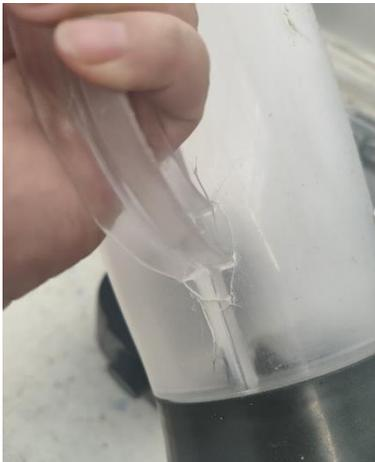
Figura 10: Vaso de licuadora fracturado
