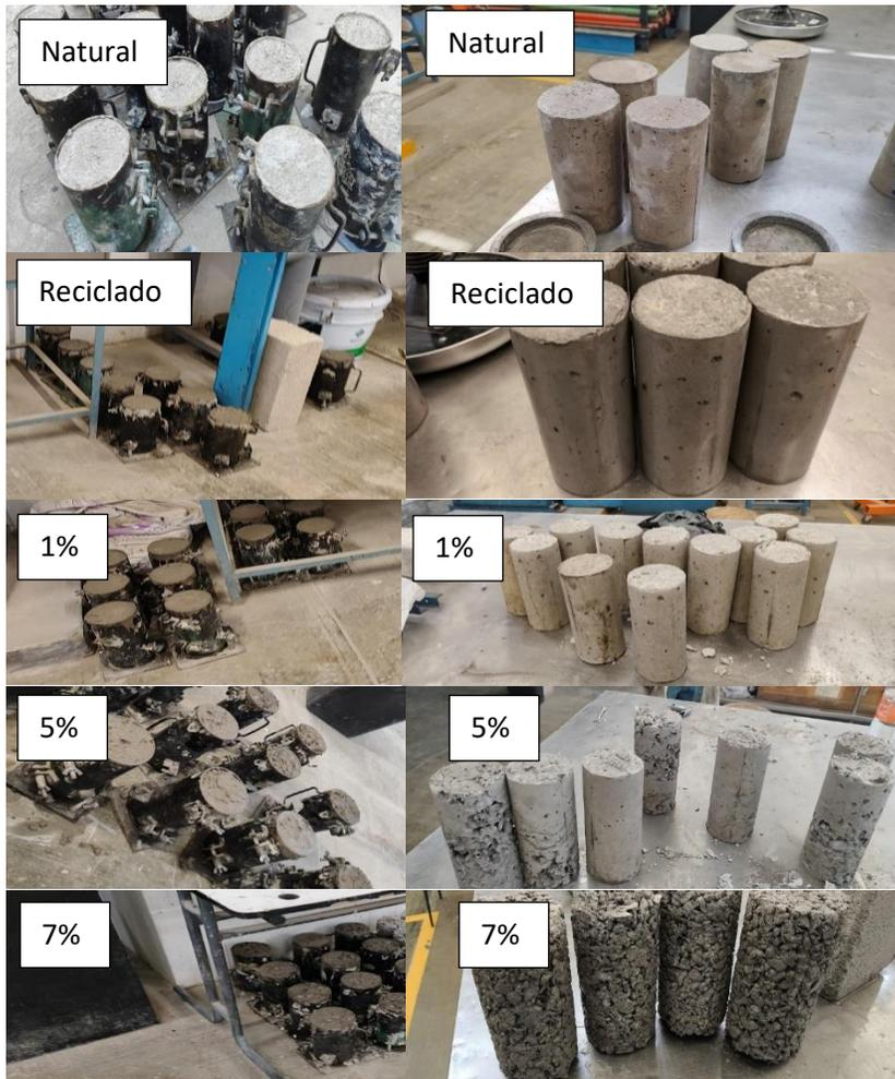
Figura 44: Distintas mezclas en su molde y textura de desmoldado.
