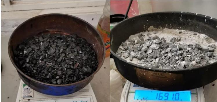
Figura 33: Pesado de material reciclado antes y después del secado
