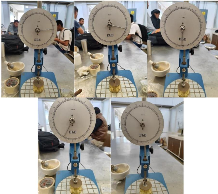
Figura 37: Valores de penetración (mm) material reciclado
