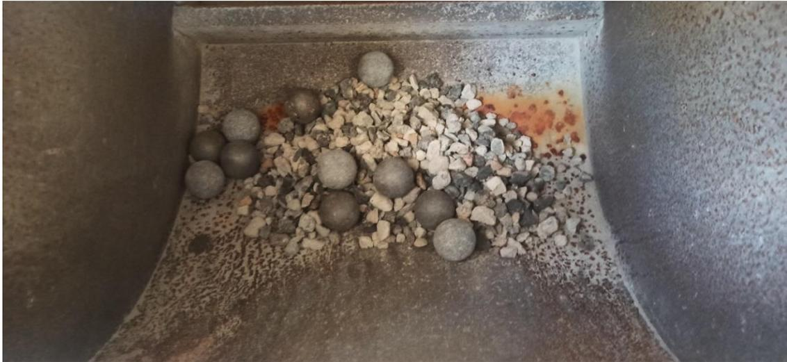
Figura 28: Material para prueba de desgaste de los Ángeles
