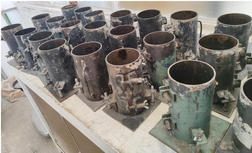
Figura 40: Moldes de 10x20 usados para los cilindros
