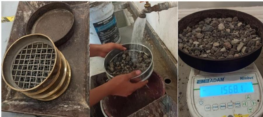
Figura 29: Mallas, lavado y pesado del material después de la prueba del desgaste de los Ángeles
