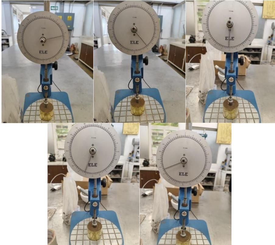
Figura 35: Valores de penetración (mm) material natural
