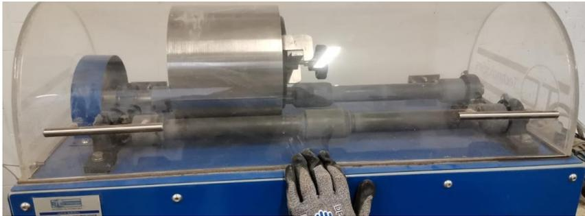
Figura 31: Maquinaria para la prueba de desgaste micro-deval
