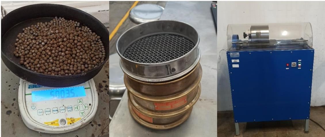
Figura 32: Bolas de acero, mallas y maquinaria para el desgaste micro-deval
