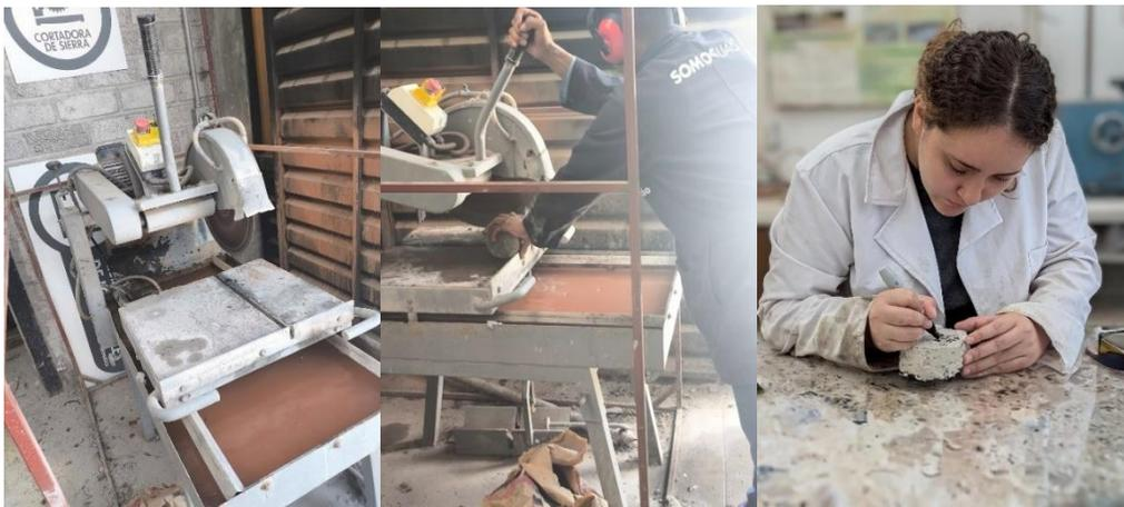
Figura 53: Máquina de corte, proceso del corte y marcado de las pastillas.
