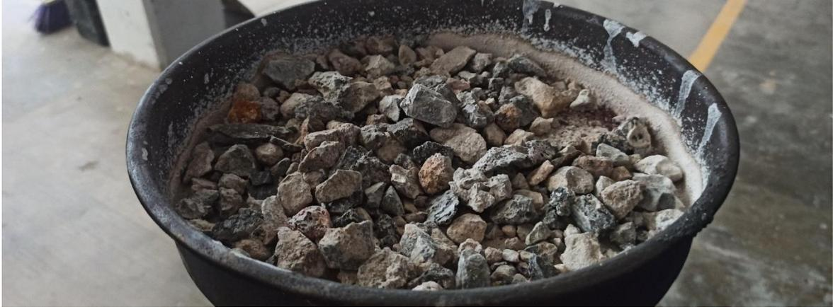
Figura 30: Material reciclado en uno de los ciclos de secado de la prueba de Intemperismo.
