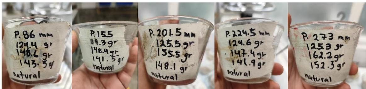
Figura 36: Contenido de humedad de las distintas penetraciones (gr), material natural
