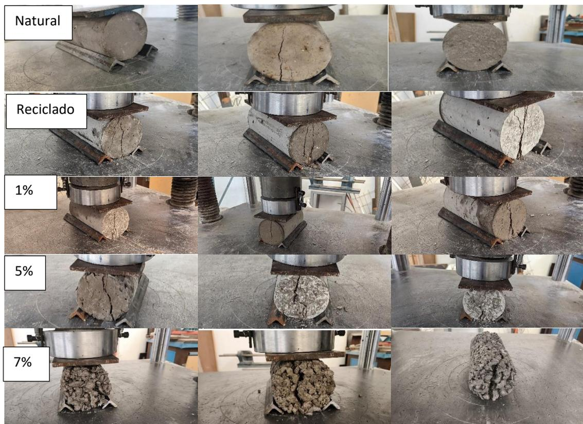
Figura 50: Cilindros ensayados a tensión, 14 días.
