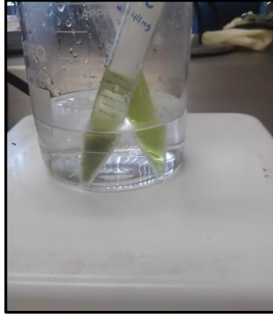
Figura 15. Extracción de lípidos totales de microalgas en baño María
