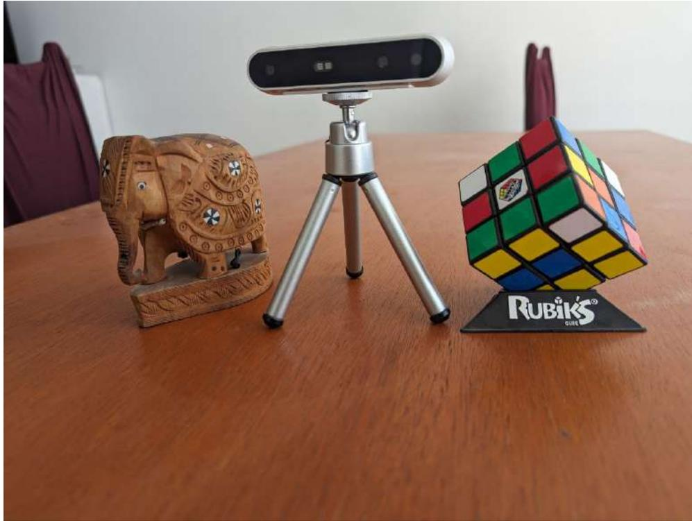
Figura 2.3: RealSense D415 RGB-D junto con dos objetos de referencia. (Propia, 2023).
