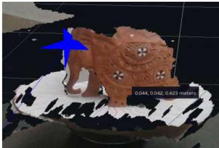
Figura 6.2: Captura RGB-D del sensor RealSense de Intel.
