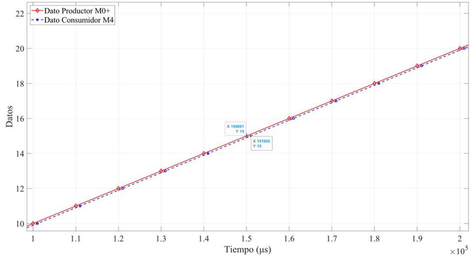
En la Figura 22 se puede observar que la variabilidad se mantiene baja en las muestras realizadas durante aproximadamente 1 minuto utilizando un buffer de 16 bits. Se observa un máximo de 1.002 ms y un mínimo de 1 ms en las diferencias de tiempo de las operaciones de escritura y lectura.
