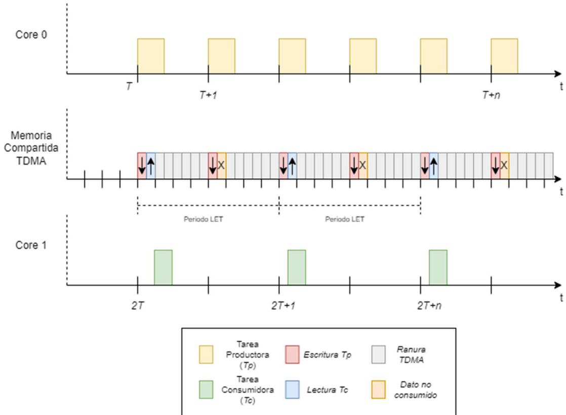
Finalmente se debe seleccionar una de las tareas del par  $T_P T_C$  como la iniciadora del evento para la activación de su tarea correspondiente en el núcleo adyacente. Esto solo se debe realizar una vez al momento de arrancar del planificador de tareas. En la
