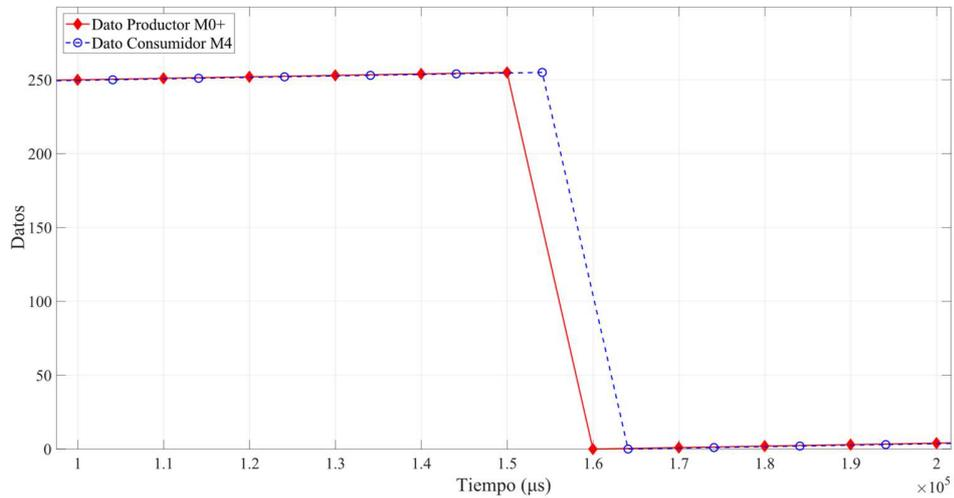
Se puede observar que el tiempo entre operaciones de lectura y escritura no es variable, sin embargo, este comportamiento solo es válido durante ese ciclo de ejecución. En ciclos posteriores se puede observar que la latencia es variable entre ciclos de ejecución, debido a que los tiempos de inicialización pueden variar, ya sea por factores internos, como la carga de datos desde memoria no volátil (NVM) así como por factores externos, como la inicialización de adquisición de datos del depurador.
