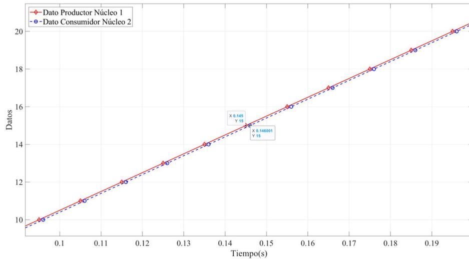
En la Figura 18 se puede observar el comportamiento de la simulación donde el tiempo entre operaciones de lectura y escrituras es de 1 ms. Esto muestra el comportamiento ideal esperado de LET-TDMA, el cual sirvió de referencia para calcular el Error Cuadrático Medio (ECM) con los resultados arrojados por la implementación descrita en la sección *Implementación de LET-TDMA en tarjeta de desarrollo*.
