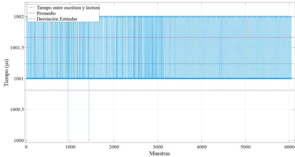
En la Figura 21, se puede apreciar la latencia de 1 ms entre la tarea productora y la tarea consumidora utilizando un buffer de 16 bits. Como se puede observar, el tamaño de datos del buffer no influye en los tiempos de transmisión, manteniendo la latencia con muy baja variabilidad. Tampoco existe una variación entre ejecuciones con distintas configuraciones, como sucede con implementaciones de LET en distintos núcleos.
