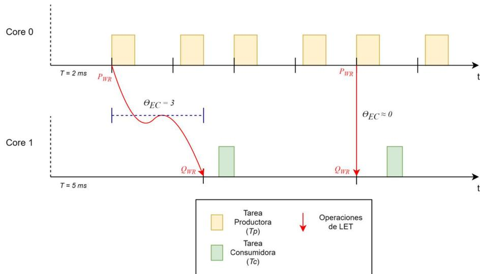
Como se puede apreciar, el mínimo común múltiplo de  $T_1$  y  $T_2$  no es igual a  $T_2$ , dado que  $MCM(2,5) \neq 5$ , como se especifica en la Ecuación 1. Sin embargo, agregando tiempos de desfase en las tareas, es posible ajustar los tiempos de latencia para que sean constantes. En el trabajo desarrollado por Martínez et al. (2018a), se propusieron las Ecuaciones 5 y 6 para considerar los desfases.
