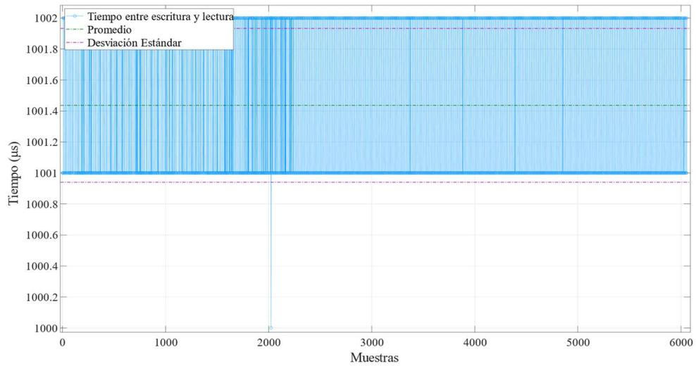
La Figura 23 muestra la latencia constante de 1 ms entre la tarea productora y la tarea consumidora utilizando un buffer de 32 bit, confirmando los resultados anteriores, utilizando el tipo de dato del tamaño de palabra del procesador.
