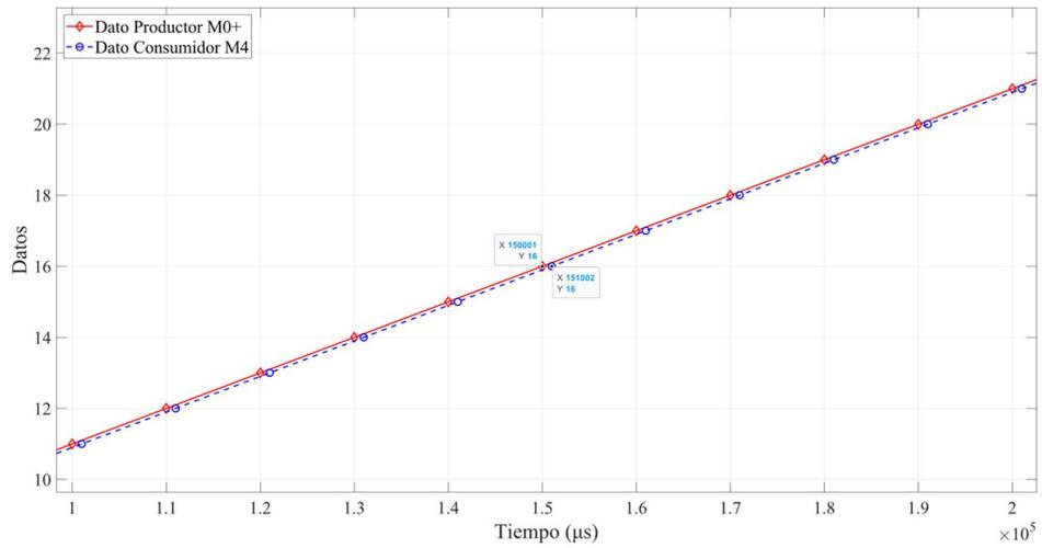
Para poder observar con mayor detalle la baja variabilidad de la latencia, se realizó el cálculo de las diferencias de los tiempos de transmisión entre las tareas. En la Figura 20 se muestra la variabilidad de las muestras de transmisiones realizadas durante aproximadamente 1 minuto. La latencia mínima medida fue de 1 ms mientras la máxima fue de 1.002 ms utilizando un buffer de tamaño de datos de 8 bits.
