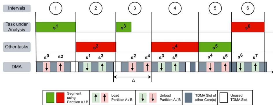
*Nota:* El diagrama representa el planificador de TDMA utilizando DMA para la transmisión de datos entre tareas en un esquema segmentado. Tomado de *Segment streaming for the three-phase execution model: Design and implementation* (p.3), por Soliman, *et al.* (2019).
