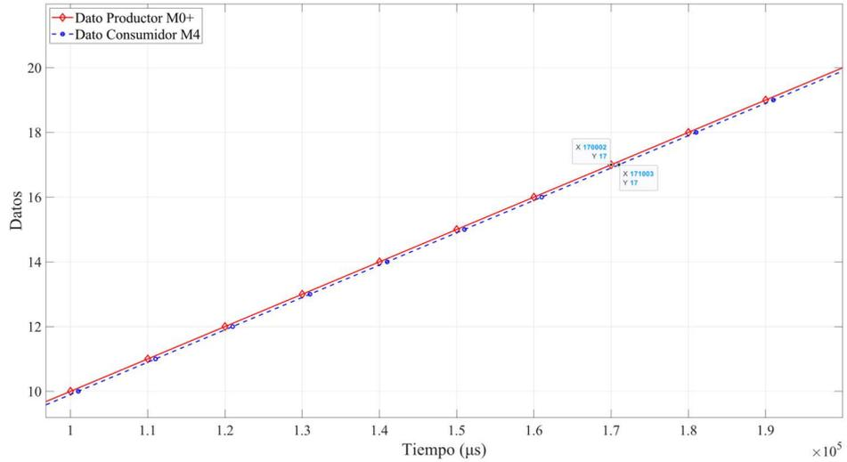
En la Figura 24 se muestran las diferencias de tiempo entre las operaciones de lectura y escritura utilizando un buffer de 32 bits. Es posible apreciar que las latencias se mantienen entre 1.001 ms y 1.002 milisegundos, manteniendo un comportamiento muy similar a los casos observados en la Figura 20 y en la Figura 22.
