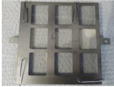
Figura 6.4. Sustrato de vidrio con mascarilla para la obtención de 9 películas delgadas de ZnTe:N.
