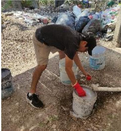
Figura 20. Toma de muestra en descargas de regadera en vivienda.
