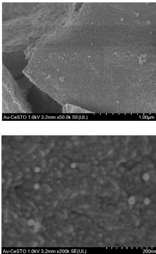
**Figura 24.** Imágenes de HRSEM para el fotocatalizador plasmónico NPsAu-Sr<sub>0.95</sub>Ce<sub>0.05</sub>TiO<sub>3</sub>, a dos escalas diferentes. Imagen de autoría propia.
