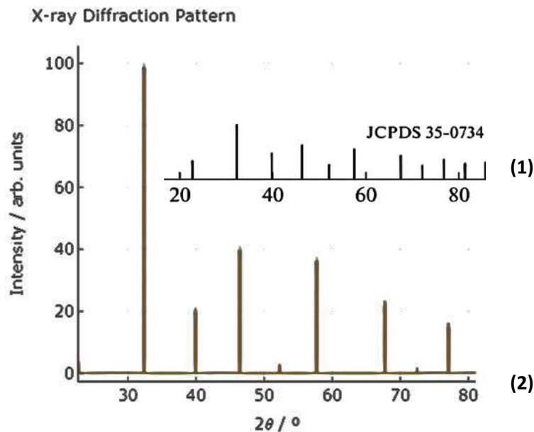
**Figura 12.** (1) Carta cristalográfica JCPDS 35-0734. (2) Difractograma  $\text{SrTiO}_3$ , grupo espacial  $\text{Pm}3\text{m}$ , tamaño de cristalito 19nm. Tomado de Materias Project, Material ID: mp-5229.
