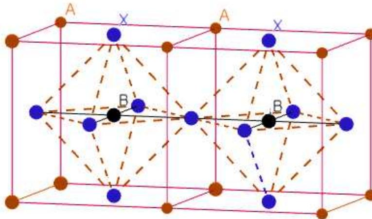
**Figura 2.** Estructura de la perovskita. Imagen de autoría propia.
