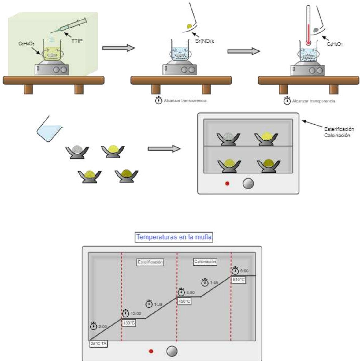
**Figura 9.** Síntesis del SrTiO<sub>3</sub> y temperaturas para la mufla. Imagen de autoría propia.
