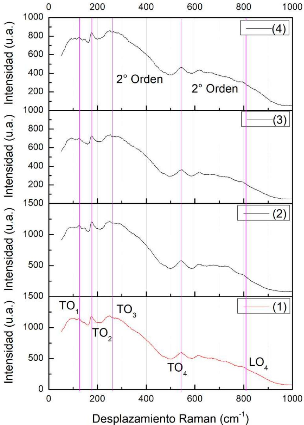
**Figura 21.** Espectros micro-Raman para los materiales: SrTiO<sub>3</sub> (1); Sr<sub>(1-x)</sub>Ce<sub>x</sub>TiO<sub>3</sub>, donde x= 0.1% (2), 0.5% (3), 1% (4). Imagen de autoría propia.
