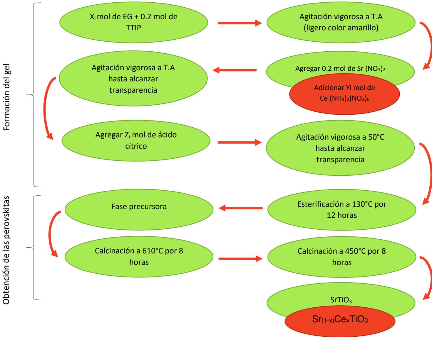
**Figura 8.** Síntesis del  $SrTiO_3$  y  $Sr_{(1-x)}Ce_xTiO_3$ . Imagen de autoría propia.
