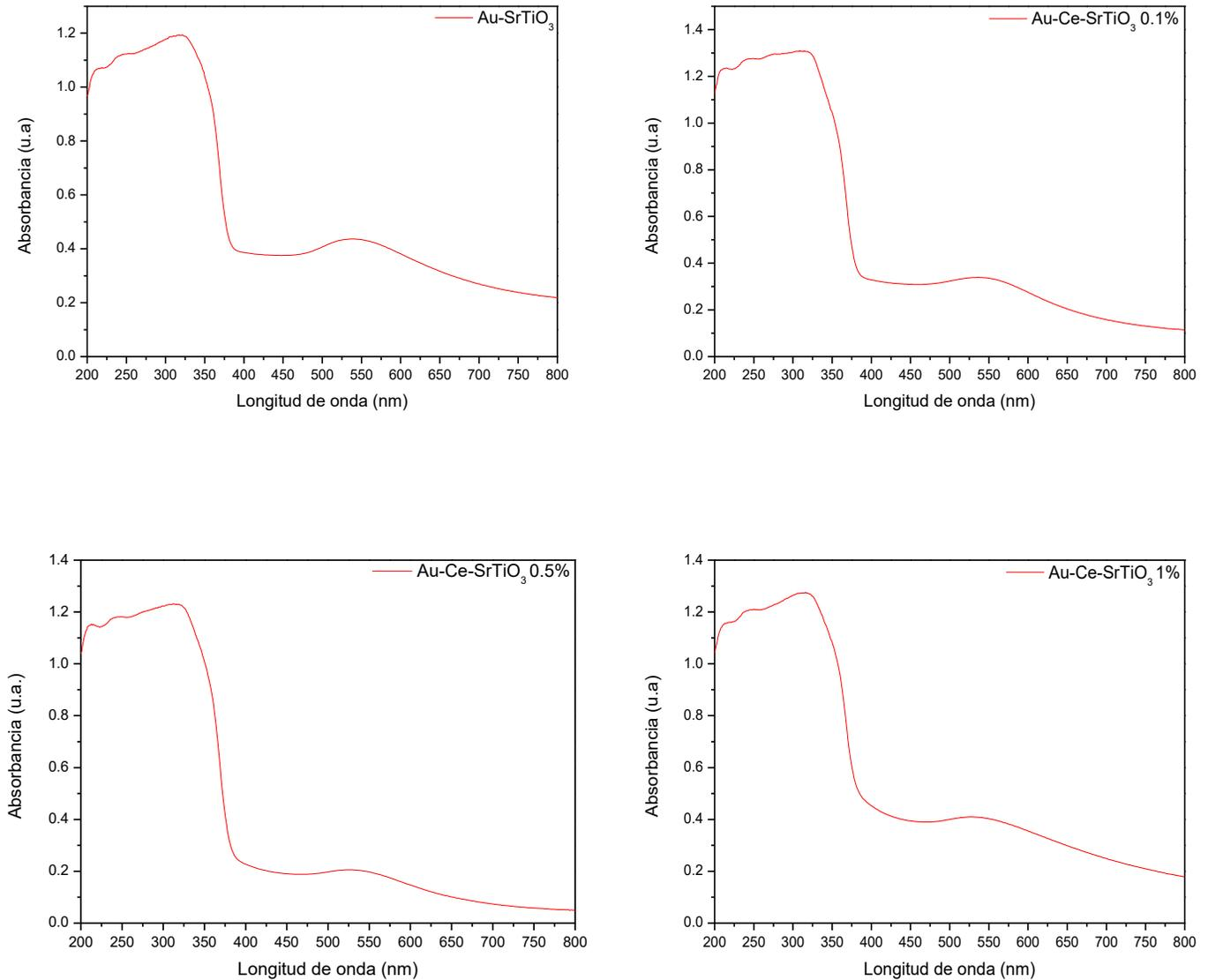
**Figura 18.** Espectros Uv-vis para los materiales: Au-SrTiO<sub>3</sub> y Au- Sr<sub>(1-x)</sub>Ce<sub>x</sub>TiO<sub>3</sub> (0.1%, 0.5%, 1%). Imagen de autoría propia.
