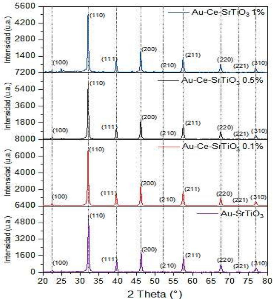
**Figura 15.** Difractogramas para los fotocatalizadores dopados con iones de Ce (IV) y decorados con nanopartículas de Au ( $\text{Au-Sr}_{(1-x)}\text{Ce}_x\text{TiO}_3$ ). Imagen de autoría propia.
