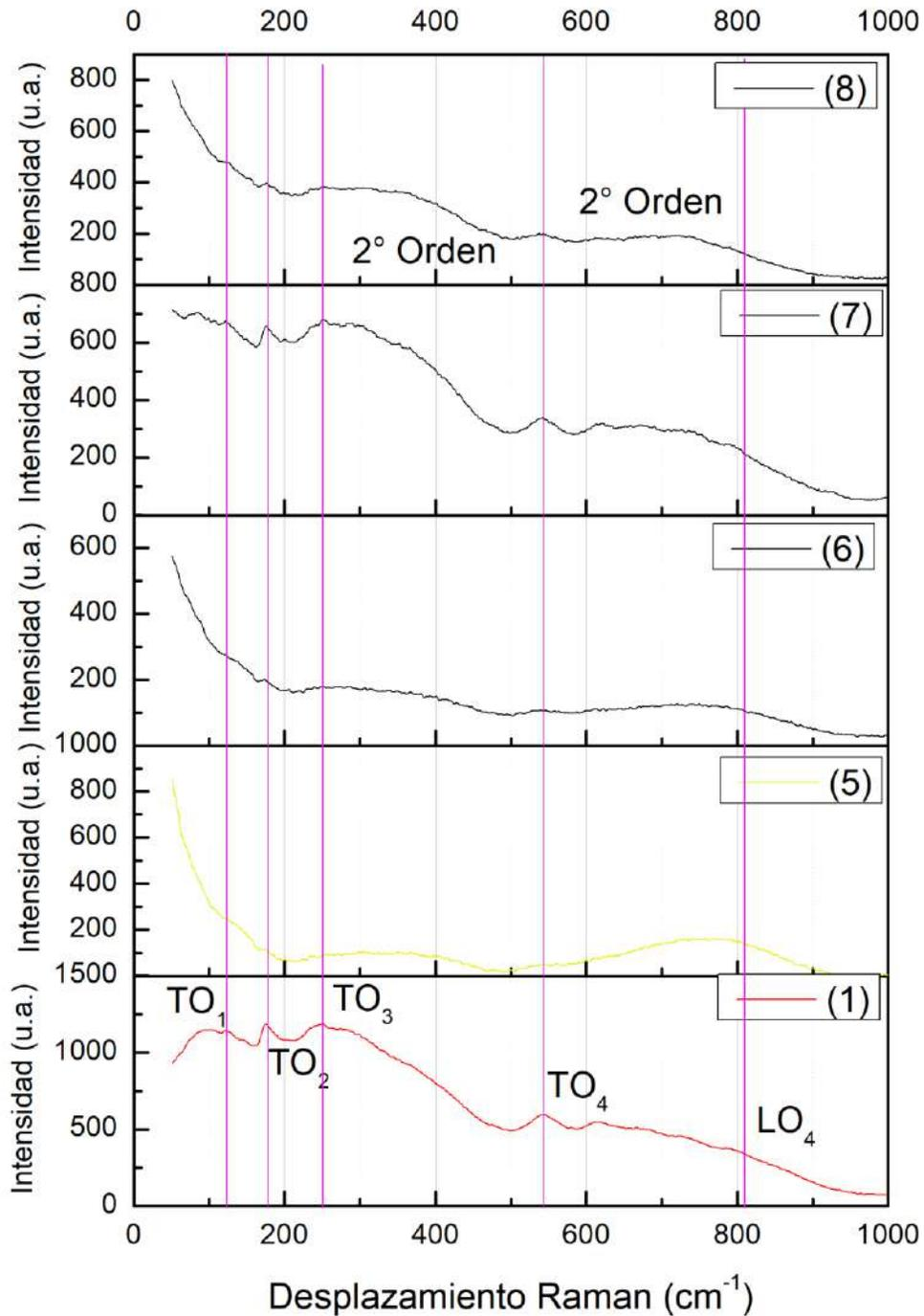
**Figura 22.** Espectros micro-Raman para los materiales:  $\text{SrTiO}_3$  (1);  $\text{Au-SrTiO}_3$  (5);  $\text{Au-Sr}_{(1-x)}\text{Ce}_x\text{TiO}_3$ , donde  $x = 0.1\%$  (6),  $0.5\%$  (7),  $1\%$  (8). Imagen de autoría propia.
