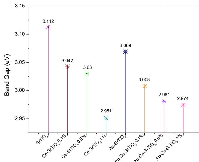
**Figura 19.** Energía de Band Gap obtenida a partir de diagramas de Tauc para los materiales  $\text{SrTiO}_3$ ,  $\text{Au-SrTiO}_3$ ,  $\text{Sr}_{(1-x)}\text{Ce}_x\text{TiO}_3$ ,  $\text{Au-Sr}_{(1-x)}\text{Ce}_x\text{TiO}_3$ . Imagen de autoría propia.
