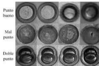
Figura 3. Defectos de RSW.
