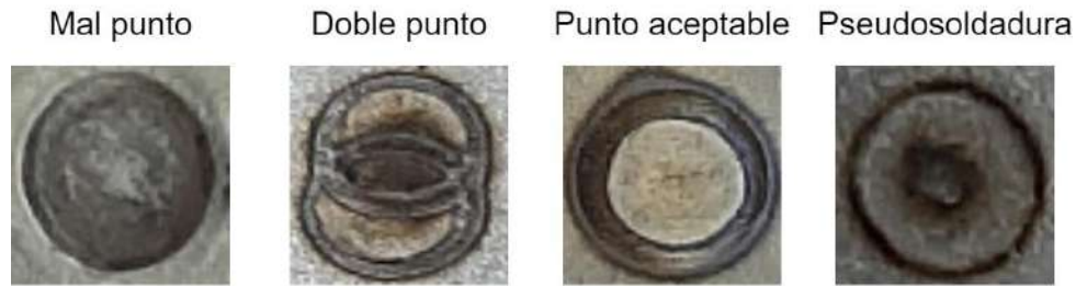
Figura 2.2 Defectos RSW (Dai et al., 2022).
