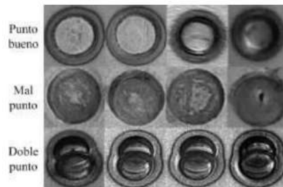
Figura 3. Defectos de RSW.
