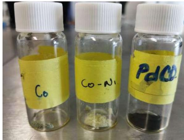
Fig. 9 Aerogeles de Co, Co-Ni y Co-Pd utilizados.
