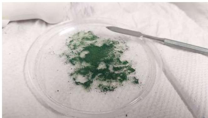
Fig. 7 Polvos obtenidos de la síntesis por coprecipitación de las NP's  $\text{Co}_3\text{O}_4$ .
