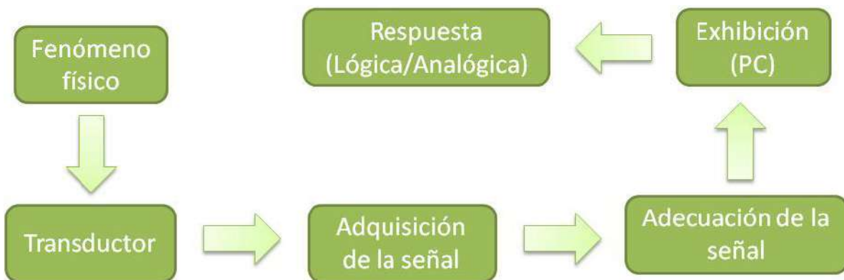
Figura 2.3 Bloque principal de un sistema automatizado
